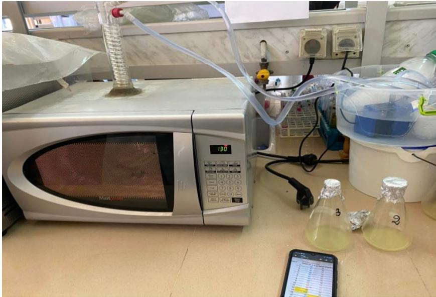
Figure 7: Photographie opération d'extraction par micro-onde.
