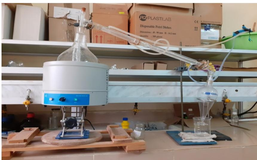
**Figure 6** : Photographie du dispositif d'hydrodistillation.
