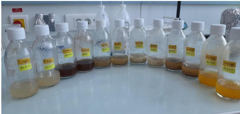
**Figure 05 :** Fermentations submergés dans des flacons.
