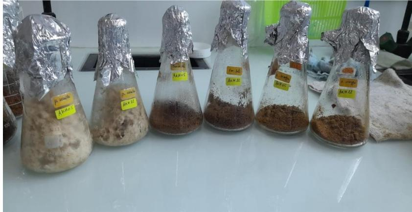
**Figure 04 :** Fermentations solides dans des Erlenmeyers de 250 ml.
