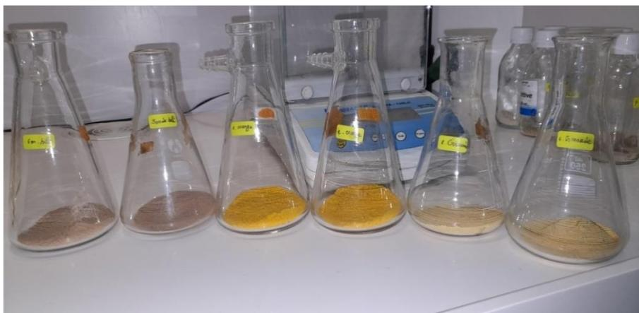
**Figure 03 :** Réalisation des fermentations solides dans des Erlenmeyers de 250 ml.
