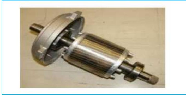
**Figure II-2:** le rotor à cage des courriels.
