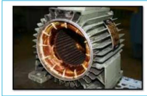
**Figure II-1:** le stator de la machine asynchrone à cage.
