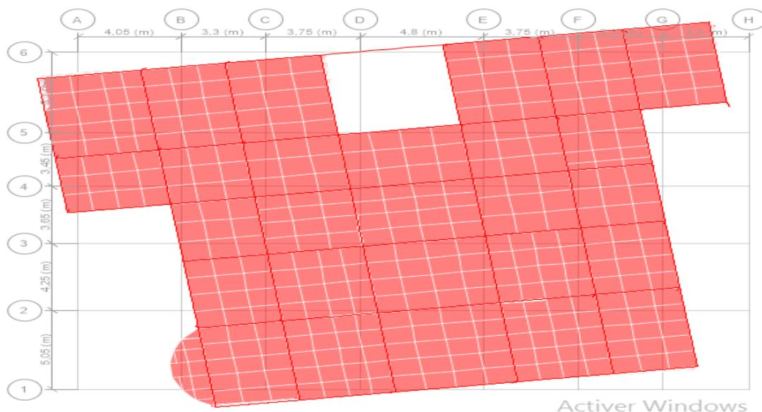
**Figure IV.6.** Mode 3 de déformation (rotation suivant Z-Z)
