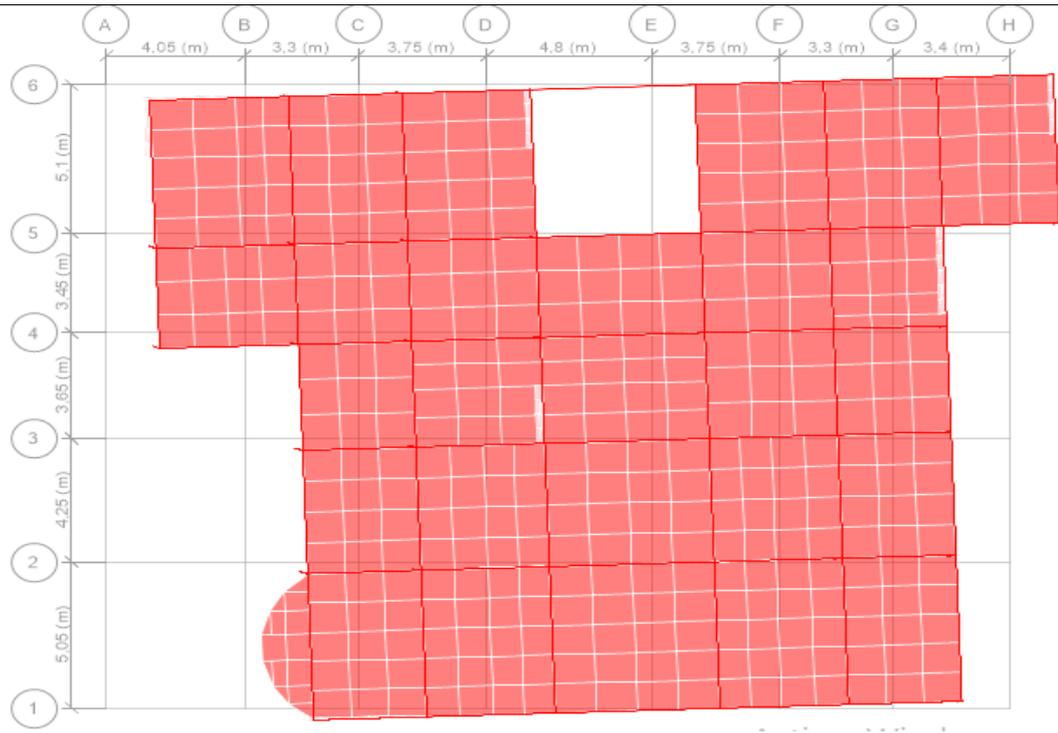
**Figure IV.4.** Mode 1 (Translation suivant l'axe X-X)
