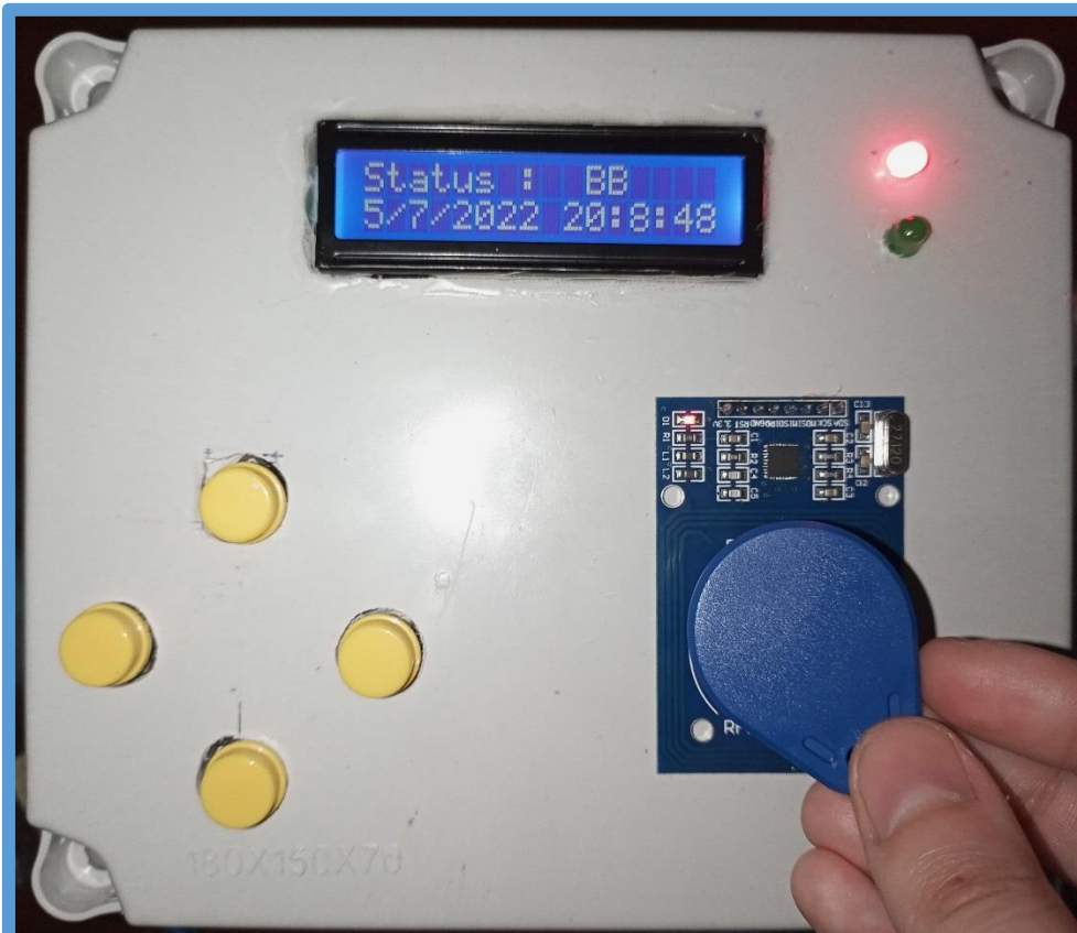
Figure 3.27: Led rouge allumée et affichage de l'heure d'arrivée de l'étudiant
