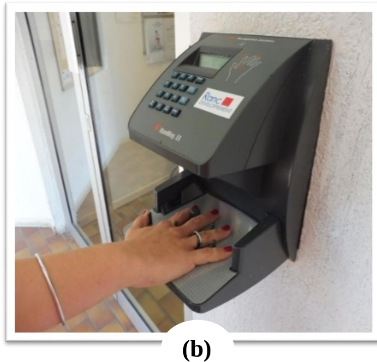
Figure 1.7: (a) Géométrie de la main, (b) Pointeuse biométrique par géométrie de la main
