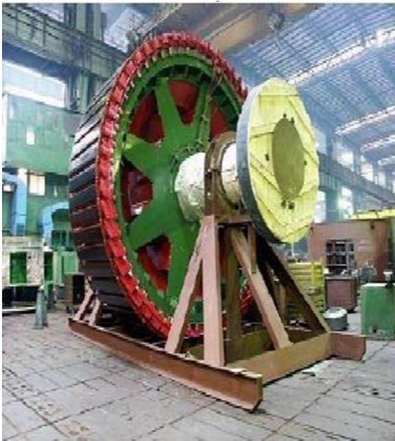
**Figure I.2 :** Rotor avec 9 phases d'un hydro générateur synchrone.
