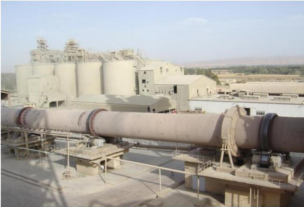
**Figure. I.4** : Four rotatif long : ligne sèche [5].
