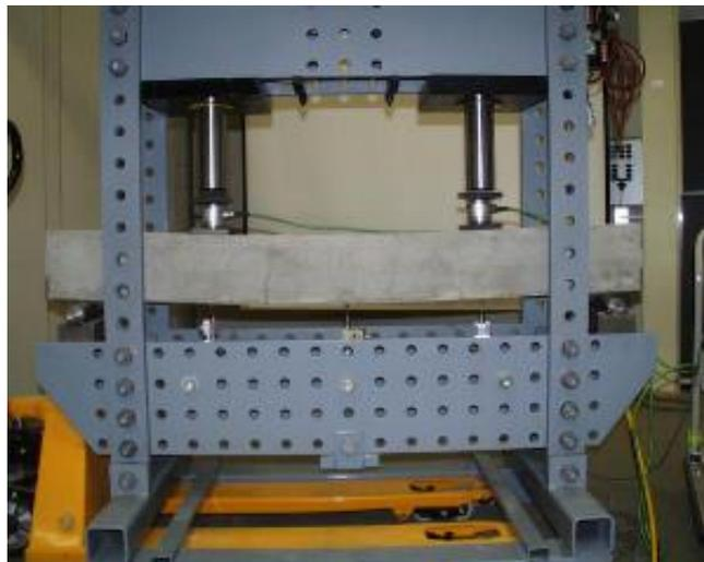
Figure. III .1 : Essai mécanique de traction
