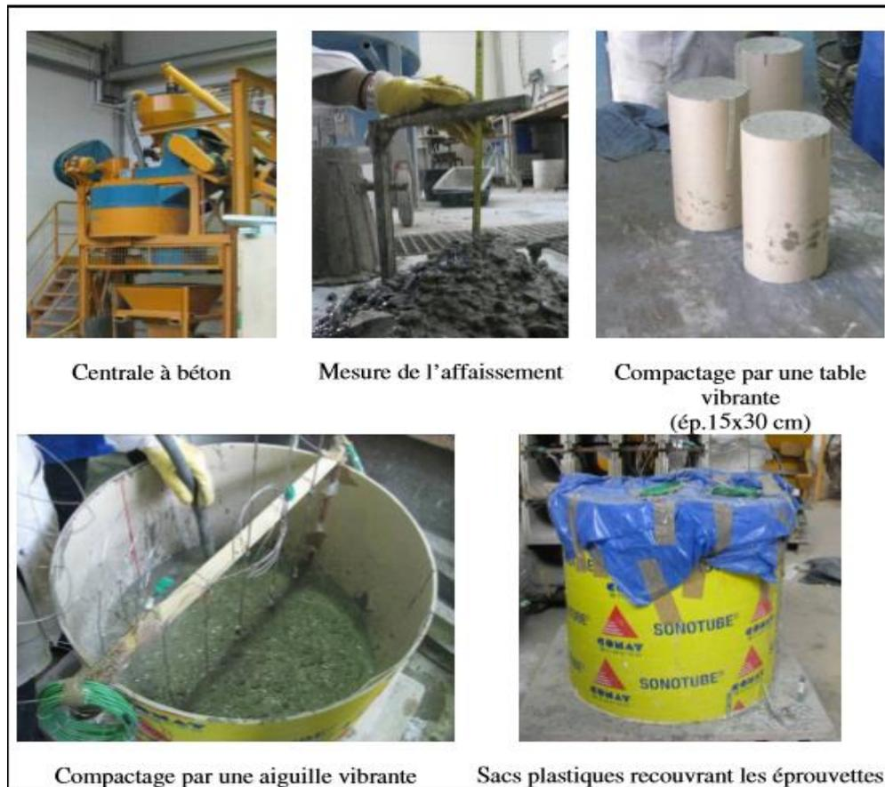
**Figure III.2.** Préparation des éprouvettes d'essai
