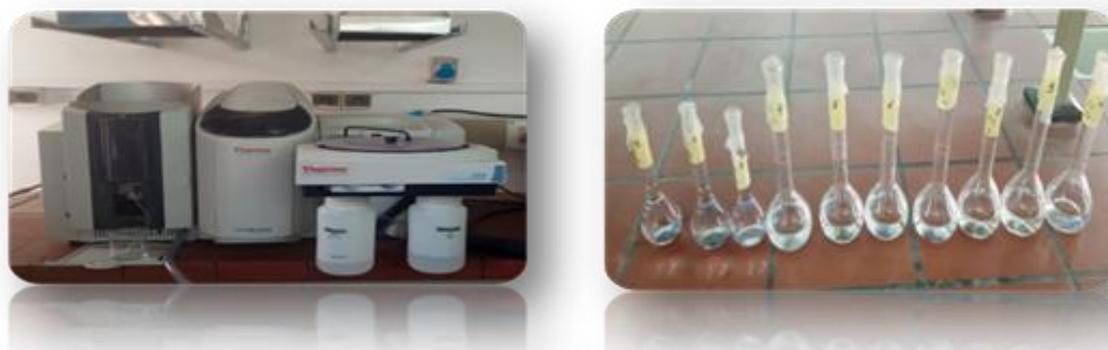
**Figure 15** : les deux photos représentent l'appareil spectrométrie d'absorption atomique (SAA) avec les étalons des métaux préparé (photos originales).
