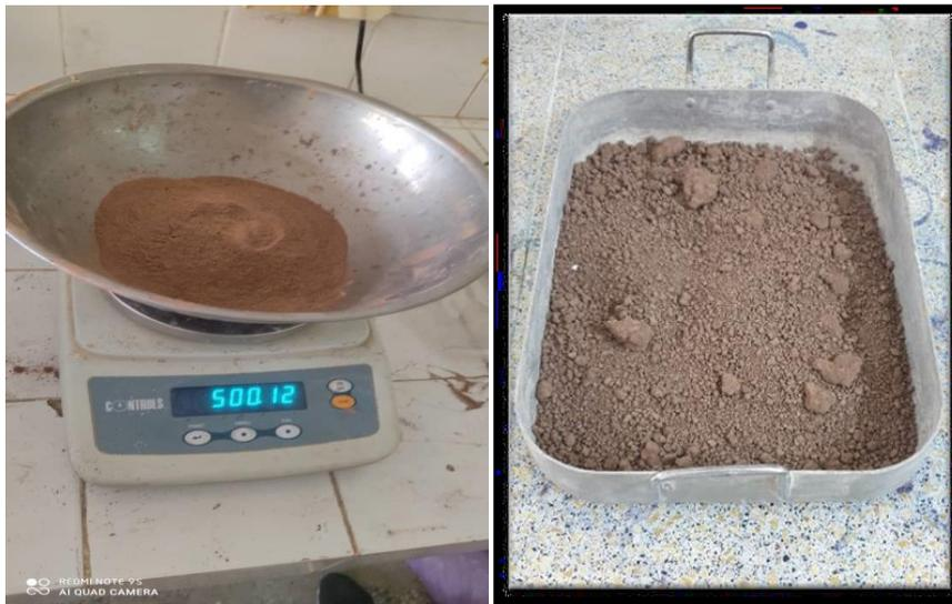
**Figure II.5:** Argile utilisée.
