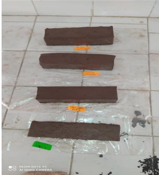
**Figure II.18:** Echantillons de brique préparés de dimension  $4 \times 4 \times 16 \text{ cm}^3$ .
