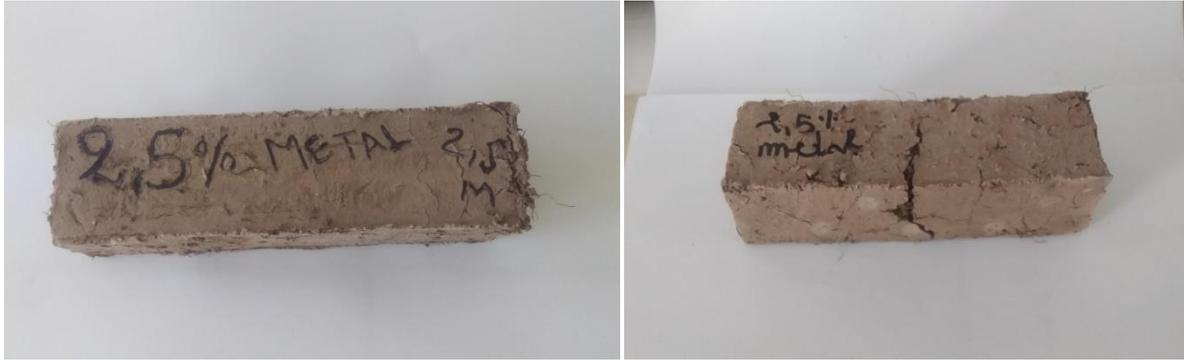
**Figure II.31 :** Brique renforcée avec des fibres métalliques avant et après les tests de flexion.
