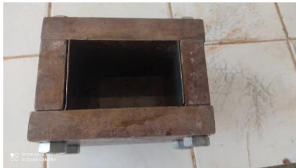
**Figure II.16 :** Moule de  $8 \times 5 \times 1 \text{ cm}^3$ .
