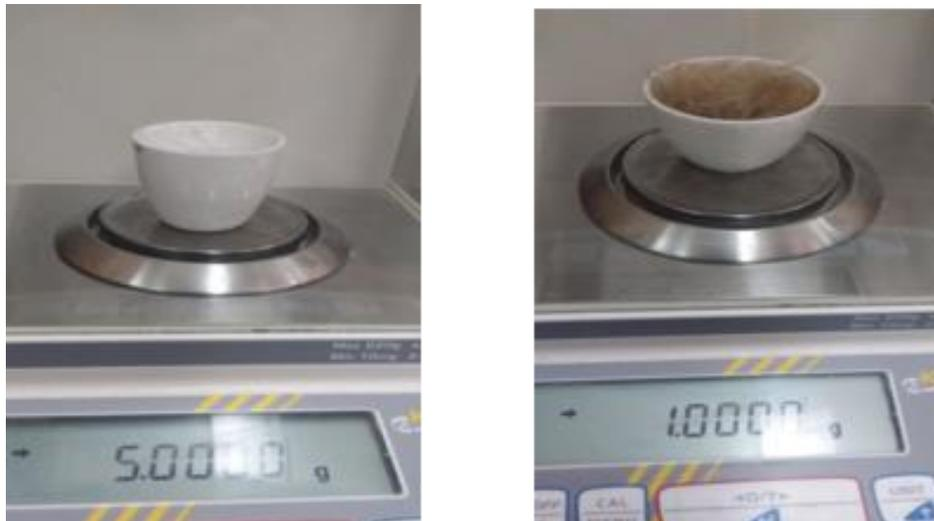
**Figure II.22 :** Creusets utilisés pour déterminer les taux de cendre.
