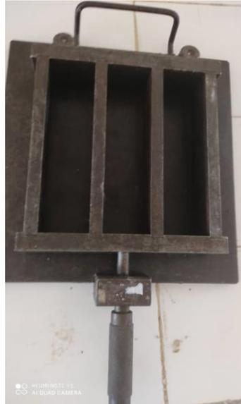
**Figure II.9:** Moule utilisée pour la matrice cimentaire de dimension  $4 \times 4 \times 16 \text{ cm}^3$ .
