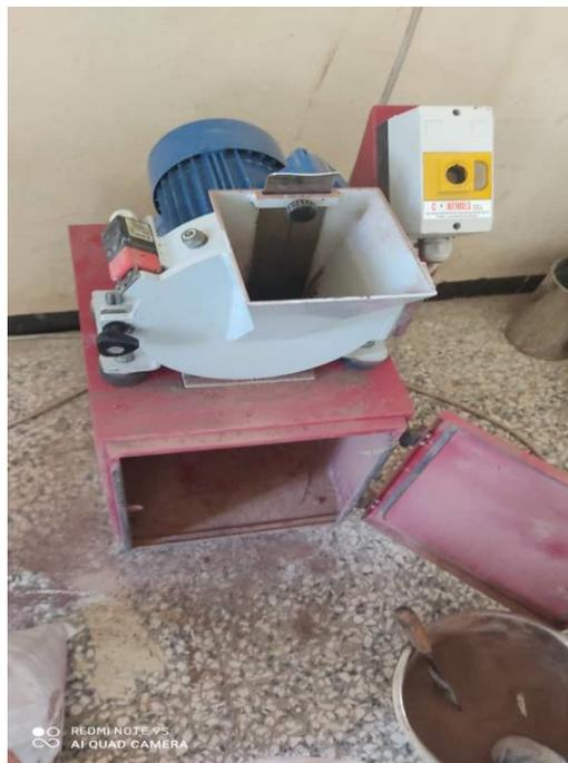
**Figure II.14** : Broyeur CONTROS de série 885/2009.
