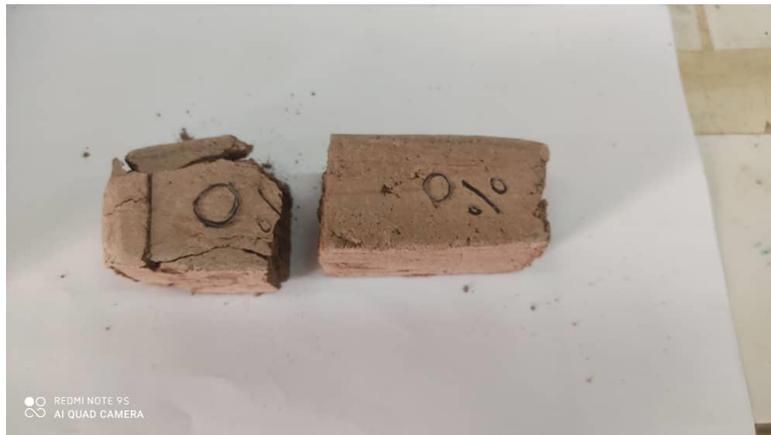
**Figure II.35 :** Brique vierge avant et après les tests de compression.
