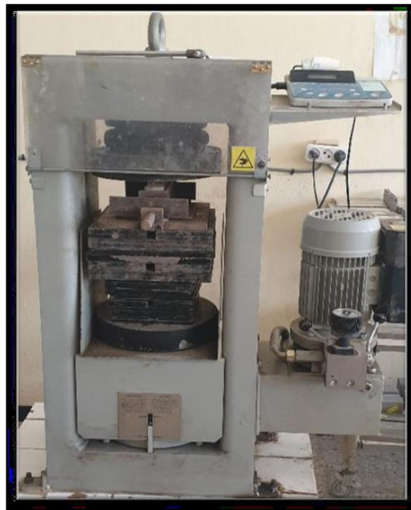
**Figure II.17:** Pressage des éprouvettes.
