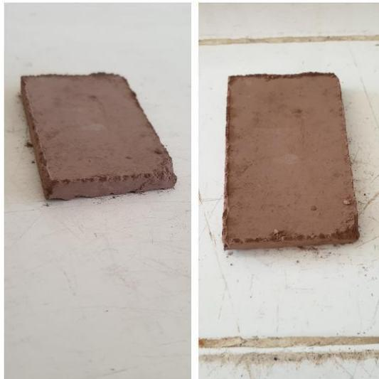
**Figure II.19:** Echantillons de brique préparés de dimension  $8 \times 5 \times 1 \text{ cm}^3$
