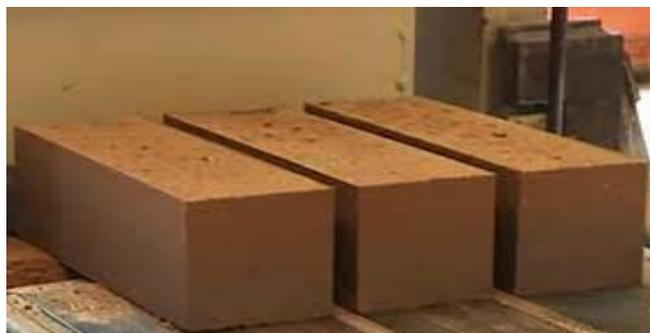
**Figure I.10 :** La brique enterre crue.
