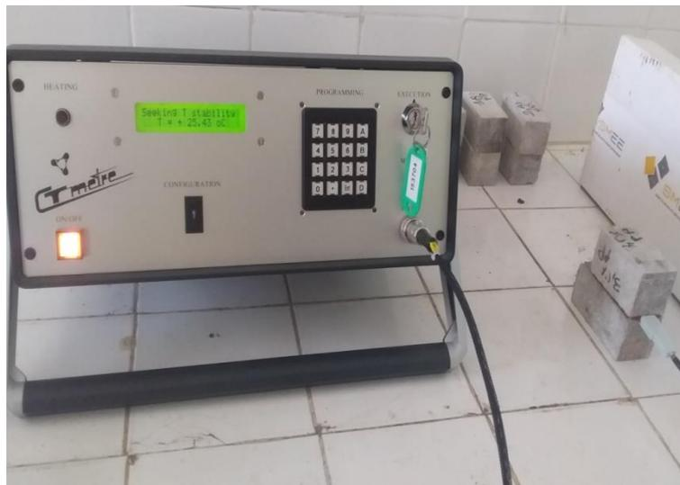
Figure III.28 : Appareil de mesure de la conductivité thermique.
