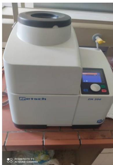
**Figure II.20:**Broyeur RETSCH de type ZM200.
