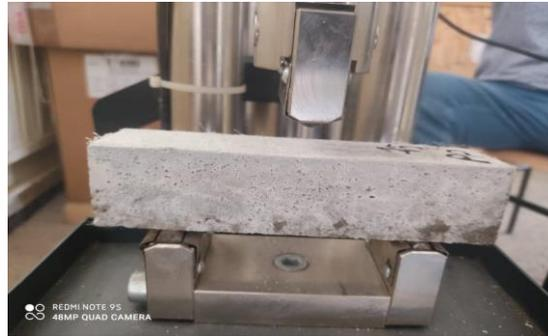
**Figure II.29** : Machine de tests de flexion.
