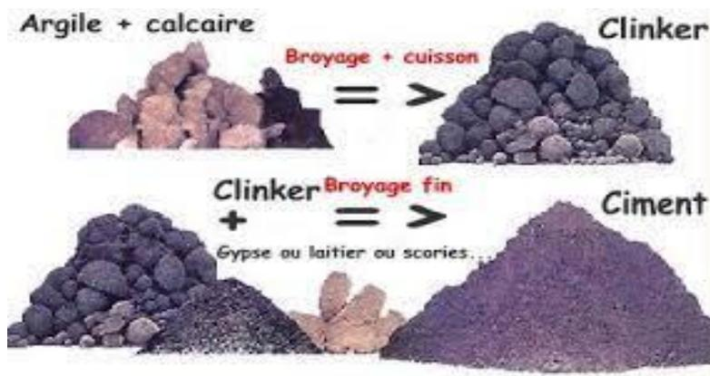
**Figure I.8 :** Fabrication du ciment
