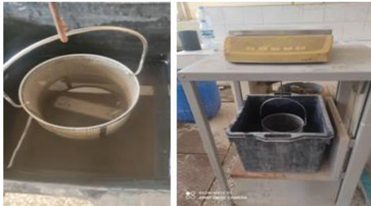
**Figure II.26** : Pesée hydrostatique sous l'eau.
