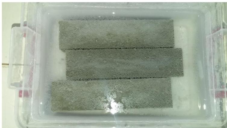
**Figure II.13:** Conservation des éprouvettes dans l'eau de robinet.
