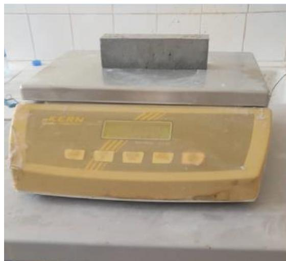
**Figure II.27** : Pesée hydrostatique à l'état saturé.
