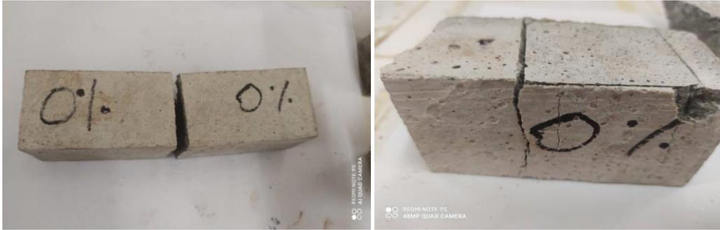
**Figure II.34 :** Eprouvette de mortier vierge avant et après les tests de compression.
