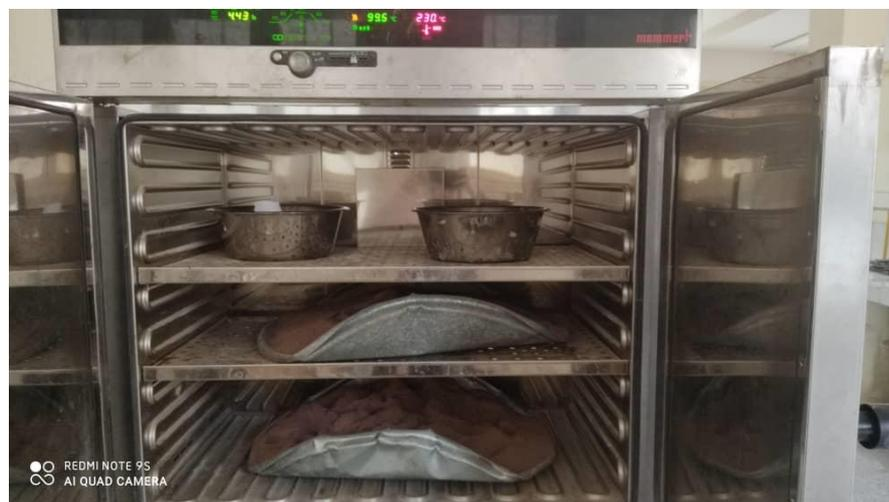
**Figure II.3**: Sable au niveau de l'étuve, 105°C pendant 24h.
