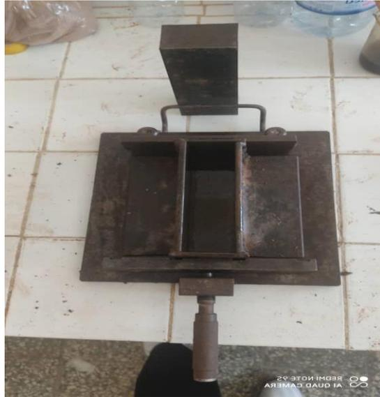
**Figure II. 15 :** Moule de  $4 \times 4 \times 16 \text{ cm}^3$
