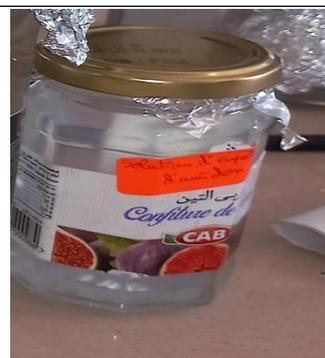
5g empois d'amidon dissout dans 50 ml d'eau puis versées dans 450ml d'eau bouillante → Solution d'empois d'amidon
