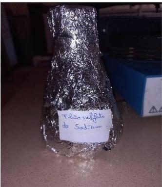
6,20g thiosulfate de sodium + 250ml d'eau distillée → solution thiosulfate de Sodium
