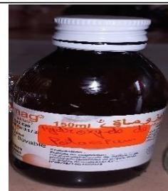
2,8g de La potasse + 100ml d'eau distillée → Agitation → solution hydroxyde de potassium
