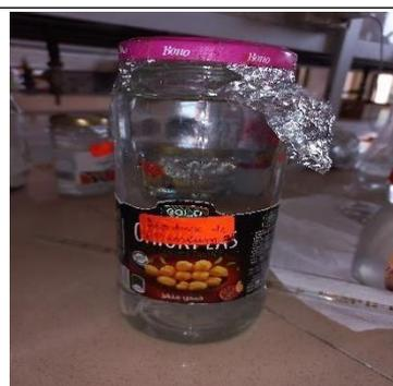
33,2 g iodure Potassium + 500ml d'eau distillée + Agitation → Solution d'iodure de potassium
