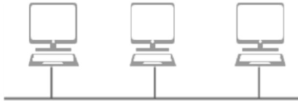
**Figure 1.2 : Topologie en bus.**
