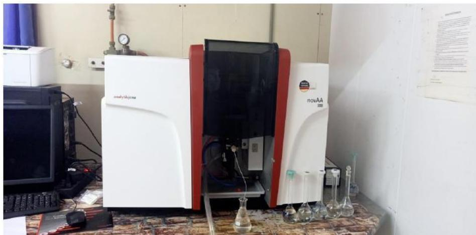
**Figure II.07. Spectromètre d'adsorption atomique (SAA) [photo prise 2022]**
