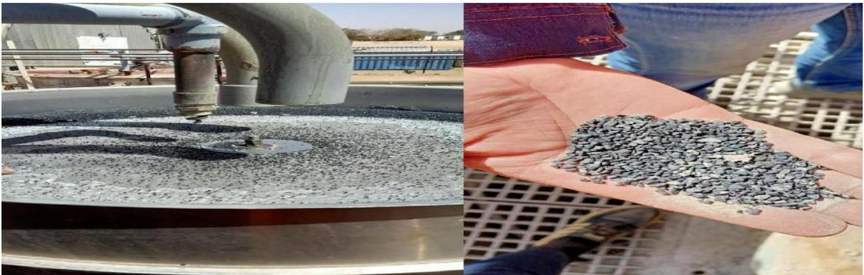
Figure II.11. Tamis vibrant et le charbon actif [photo prise 2022]
