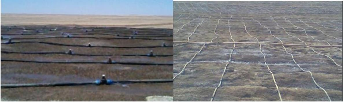
**Figure II.15. Rompe d'arrosage de cyanure au niveau de Heap Leach [17]**
