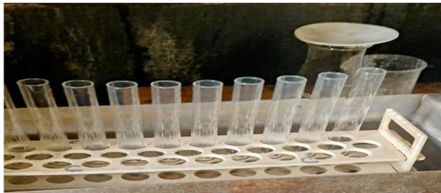
**Figure III.14. Tubes contenant les perles + HNO<sub>3</sub> sur le bain-marie pour préchauffer [photo prise 2022]**
