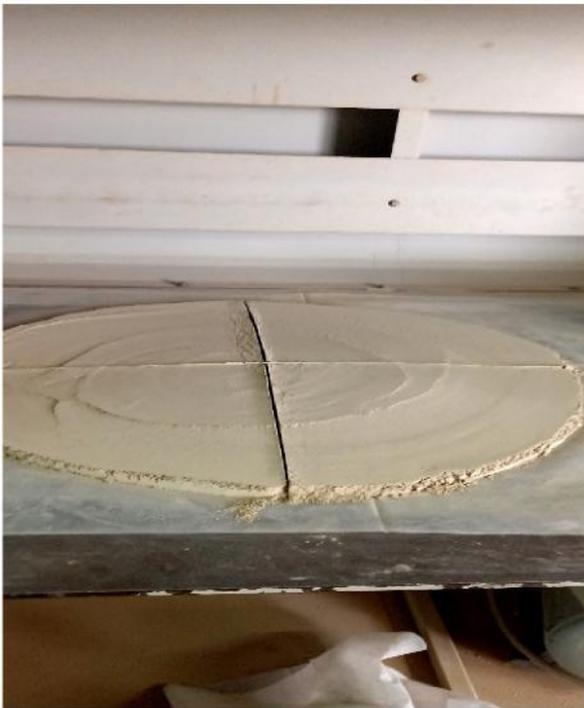
Figure III.07. Quartage de minerai après Le broyage [photo prise 2022]
