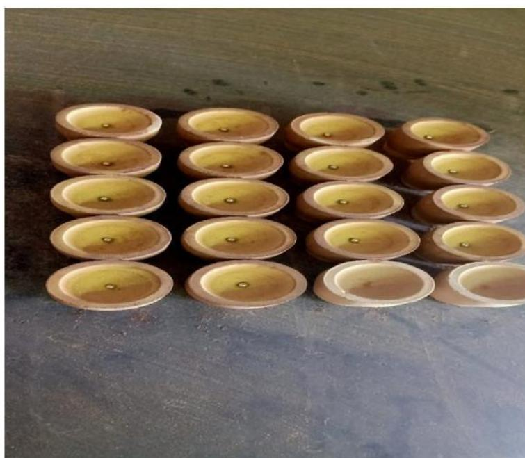
**Figure. III.13. Perle Ag-Au dans les coupelles [photo prise 2022]**
