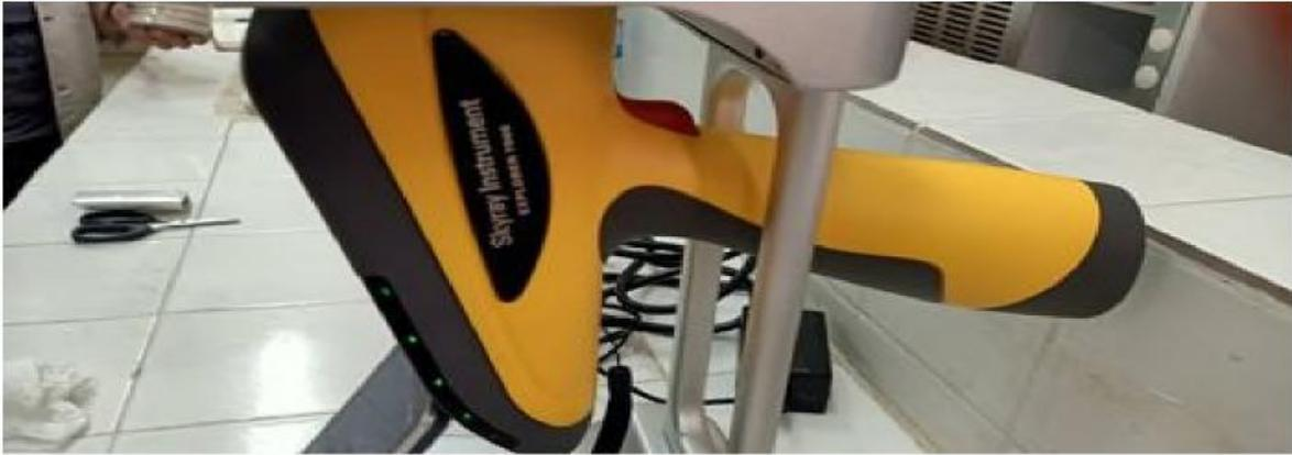
Figure III.33. Analyseur FRX [photo prise 2022]
