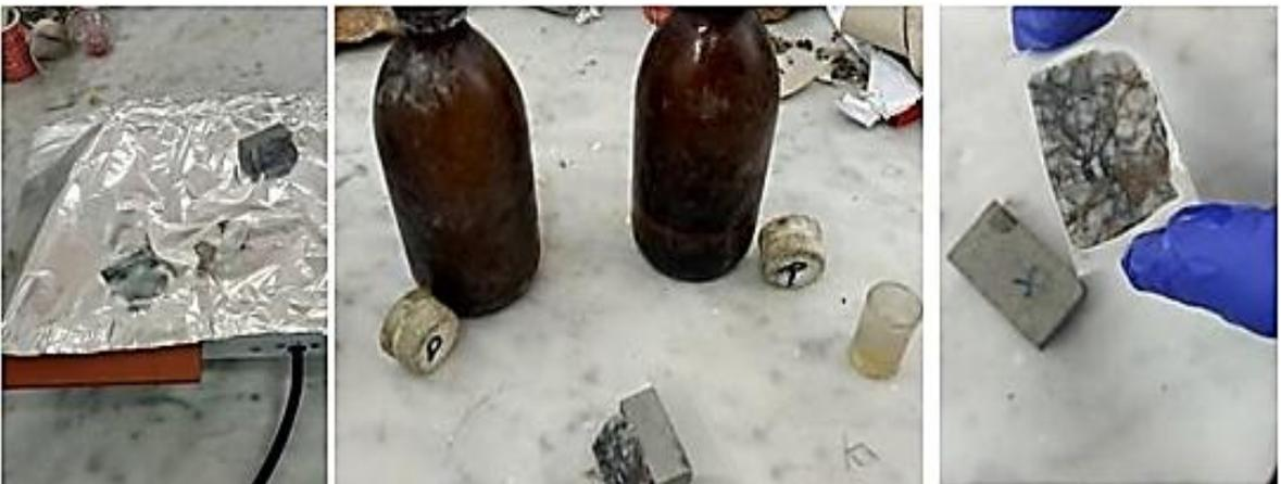
Figure III.41. Séchage + collage de verre sur le sucre [photos prises 2022]
