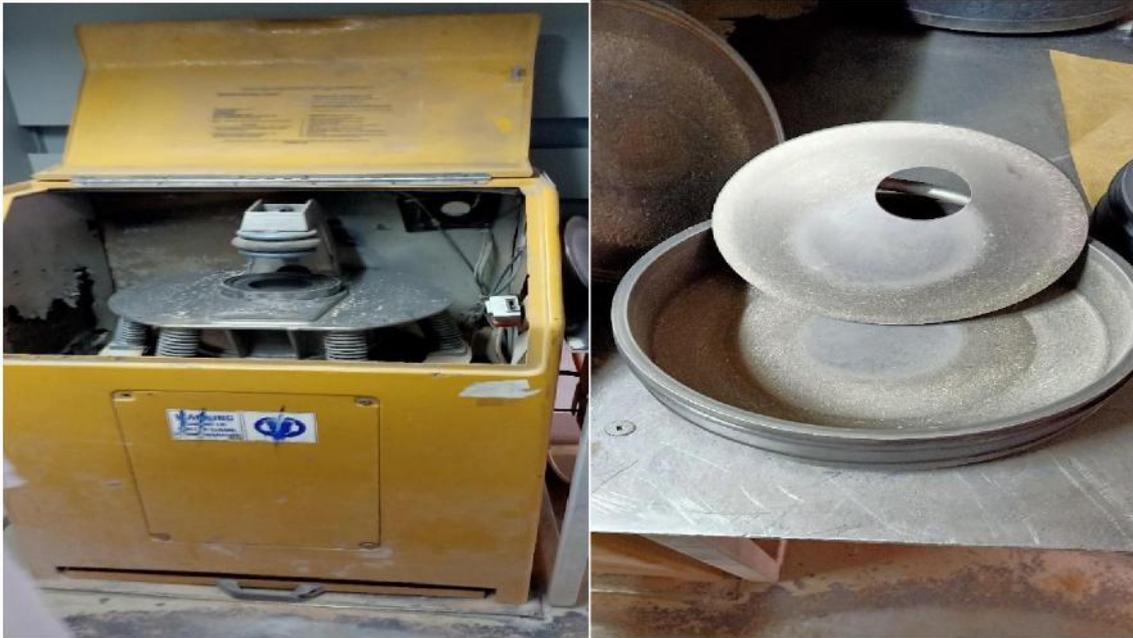
**Figure II.03. Pulvérisateur à disque du laboratoire d'Amesmassa [photos prises 2022]**
