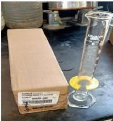
**Figure III.26. Eprouvette graduée [photo prise 2022]**
