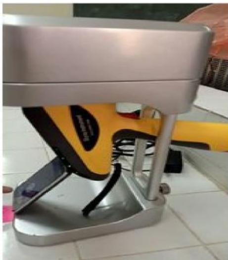
**Figure III.35.** Porteur de l'analyseur et de l'échantillon [photo prise 2022]
