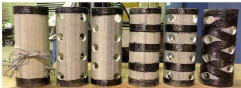
**Figure I.15.** Plusieurs configurations des tubes en GFRP [12].
