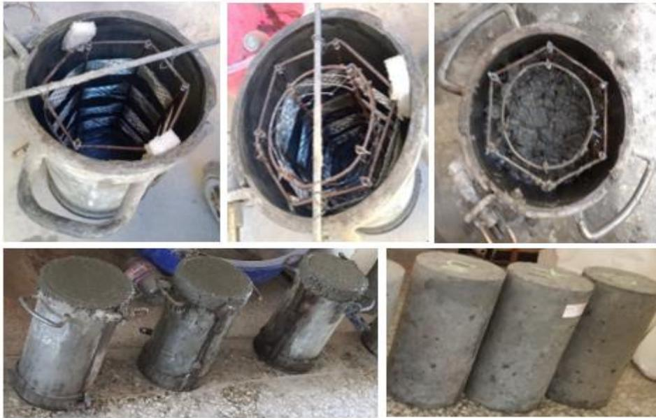
**Figure II.13.** Procédé de fabrication des différents échantillons.
