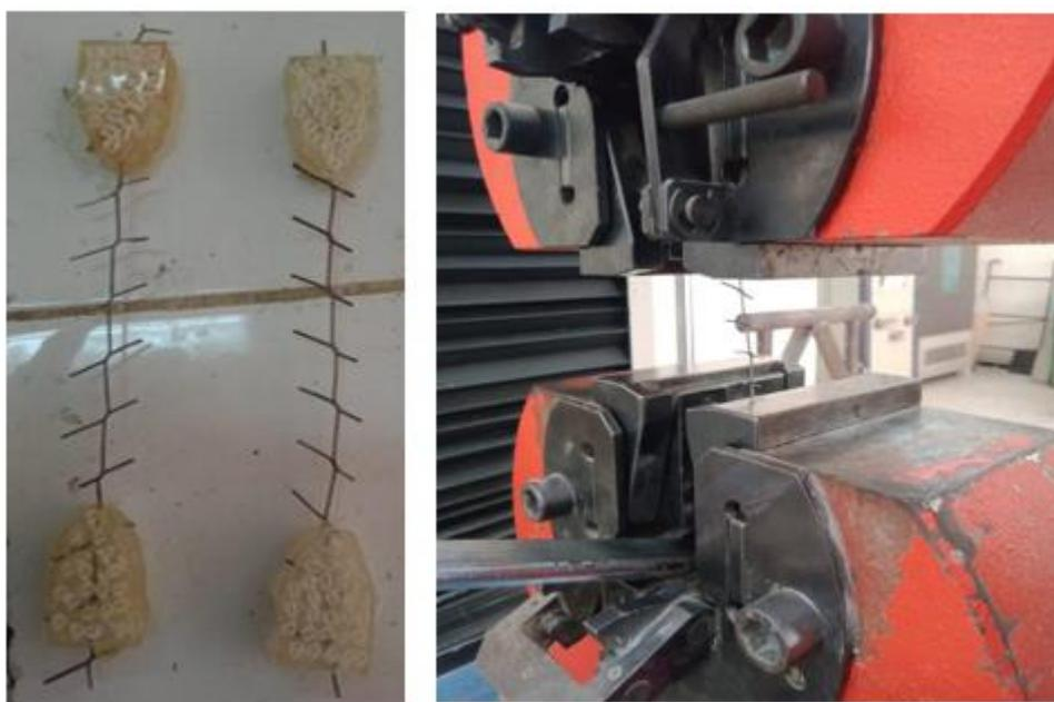
**Figure II.8.** Les éprouvettes confectionnées pour un essai de traction.
