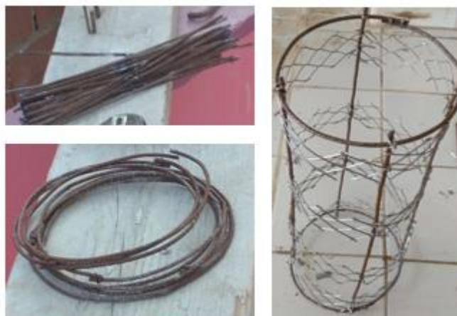
**Figure II.7.** Détail de la conception avec la grille métallique.
