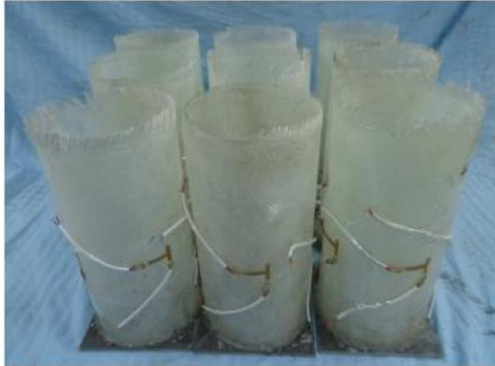
**Figure I.30.** Échantillons de tubes en GFRP proposés par Cao et al. [60].
