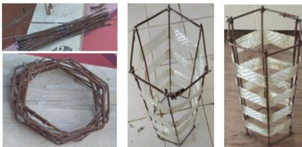
**Figure II.11.** Détail de la conception hexagonale avec le tissu GFRP.
