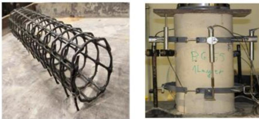
**Figure I.34.** Géo-grille et chargement des cylindres utilisés par Daou et al. 2020) [62].
