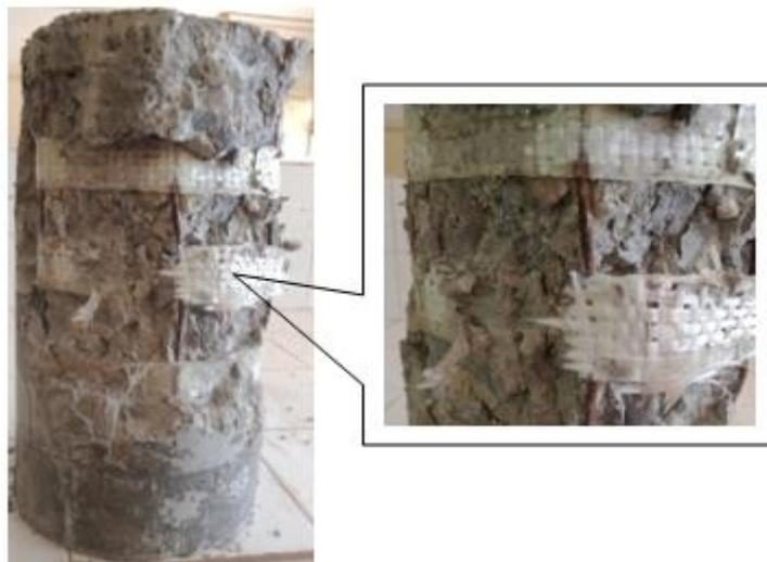
**Figure II.24.** Mode de rupture du béton confiné avec les composites GFRP.
