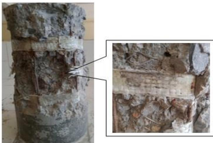
**Figure II.25.** Mode de rupture du béton doublement confiné avec GFRP et grille métallique.
