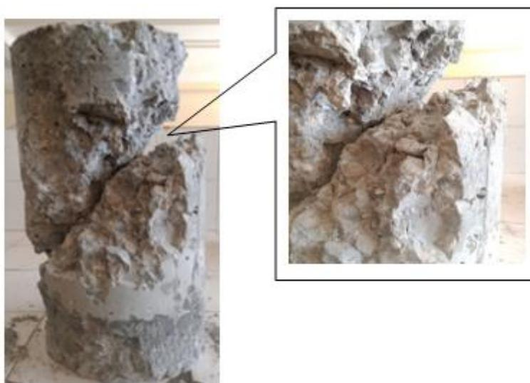
Figure II.22. Mode de rupture du béton témoin non confiné.
