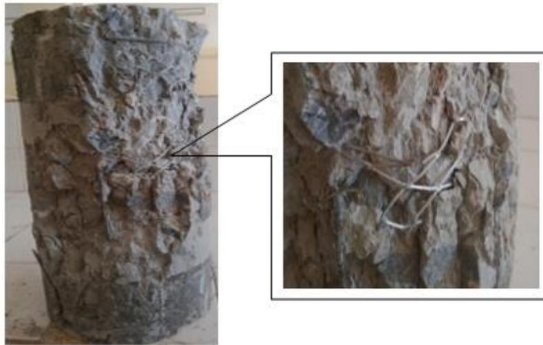
**Figure II.23.** Mode de rupture du béton confiné avec la grille métallique.
