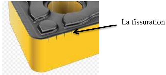
**Figure2.13.** La fissuration de l'arête.
