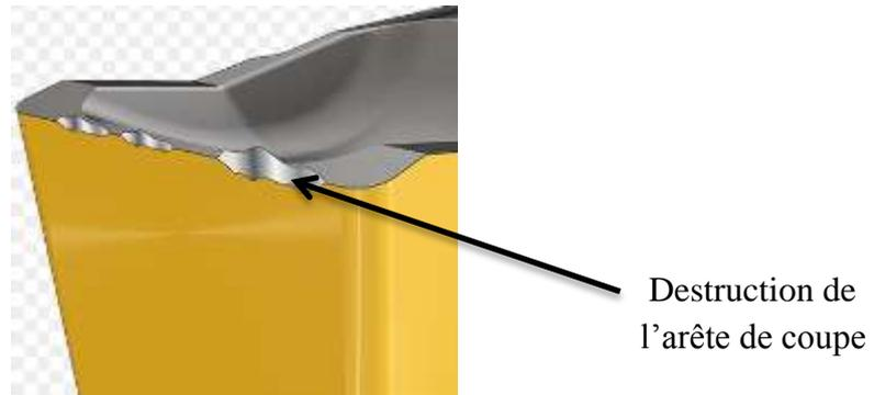
**Figure2.9.** L'écaillage de l'arête.
