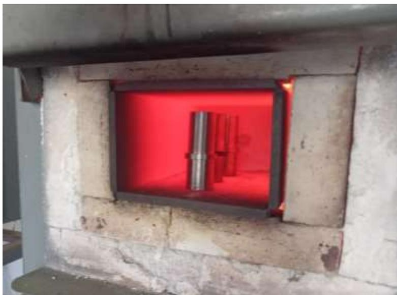
**Figure 3.12.** Positionnement des pièces.
