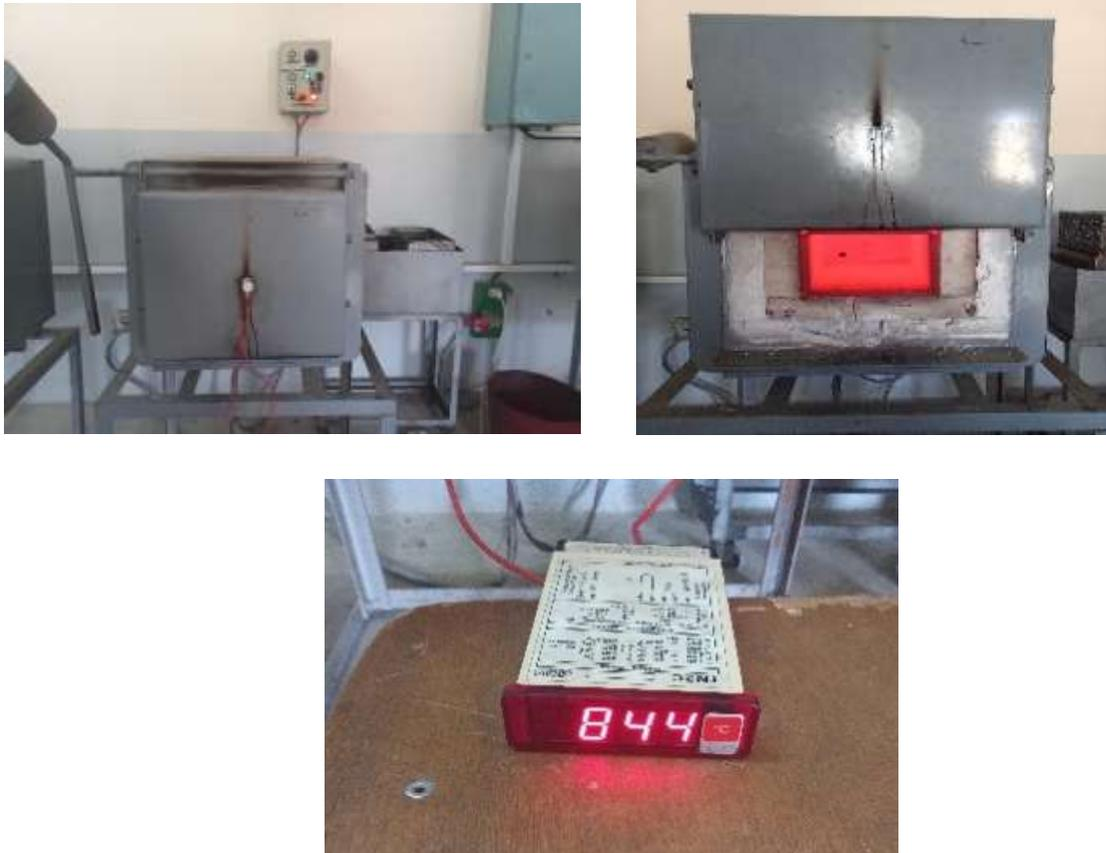
**Figure3.11.** Le four et température de chauffage.
