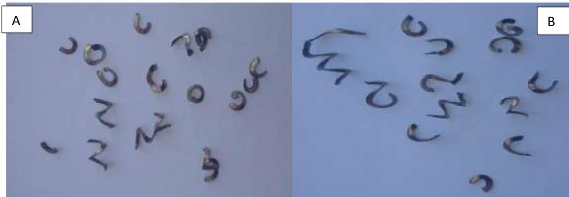
**Figure 3.9.** Copeaux obtenus lors de l'essai 03 ( $V_c=240\text{m/min}$ ) : (A) représente le copeau après la première passe de 2mm et (B) la deuxième passe.
