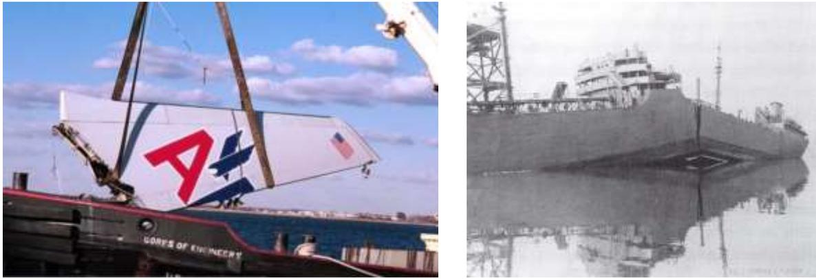
**FIGURE I.3:** Catastrophes liées au phénomène de rupture (a) accident de l'avion American Airlines Airbus-A300 [10] (b) navire Liberty Ship [11].
