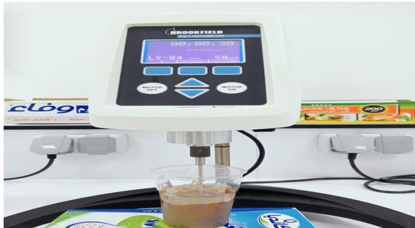
**Figure 6** : détermination de la viscosité avec le viscosimètre de type « DV1MLVKJO »
