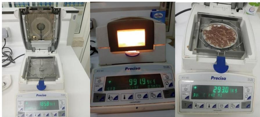
Figure 4 : Etapes de la détermination du taux d'extrait sec par dessiccateur infrarouge
