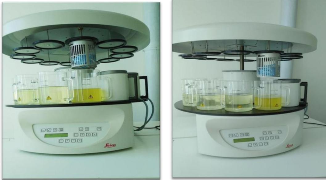
**Figure 08:** L'automate de déshydratation « LEICA TP 1020 » et le début de la circulation (photo originale).
