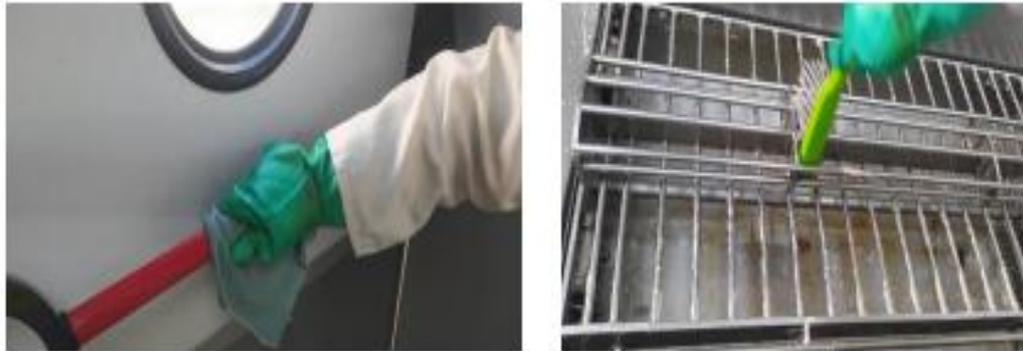
**Figure 07** : Nettoyage de la plaque doseurs
