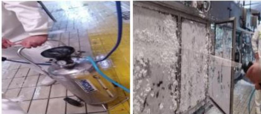
**Figure 08** : Pulvérisation de la solution moussante
