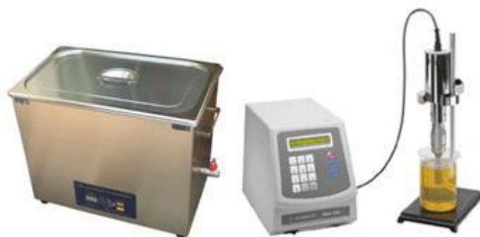
Figure 3. Dispositifs à ultrasons : bac et sonde, respectivement ( Sherbrooke 2012 ) ( Gomez-Maqueo et al., 2021 )
