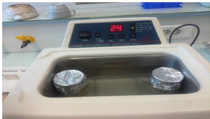
Figure 7. Extraction des CPT par ultrasons
