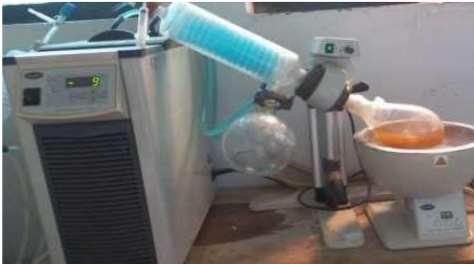
**Figure 18** : Distillation du produit avec rotavapor
