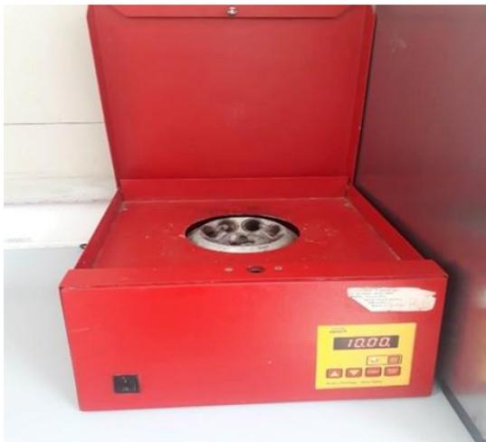
Centrifugeuse (FUNKE Gerber)
