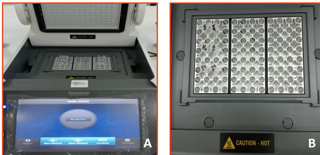
Figure 28: (A) Thermocycleur SimpliAmp, (B) le bloc thermique (photos originales).
