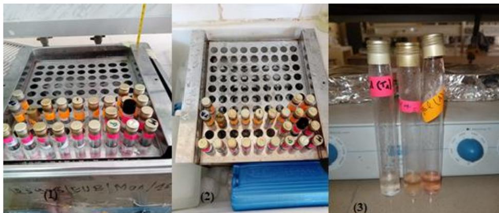
**Figure 19:** (1) Les échantillons dans un bain marie ; (2) Les échantillons dans un bain glacé ; (3) Coloration des échantillons lors du test (Original2023).
