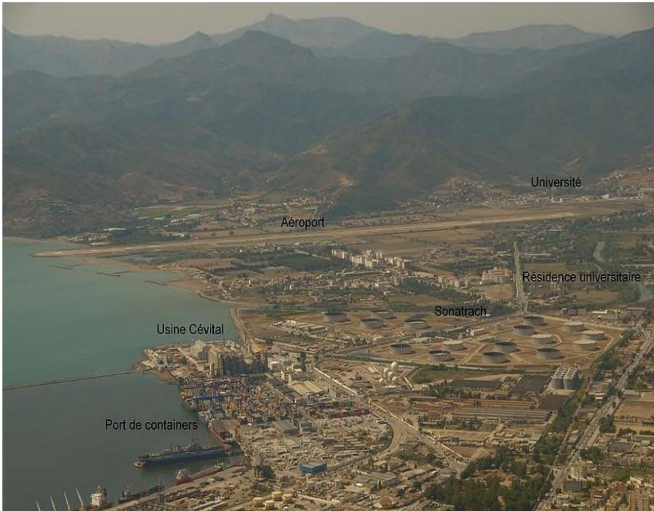
L'entreprise CEVITAL se situe à l'arrière port de Bejaia à 200 ML du quai : Ce terrain à l'origine marécageux et inconstructible a été récupéré en partie d'une décharge publique, viabilisé avec la dernière technologie de consolidation des sols par le système de colonnes ballastées (337 KM de colonnes ballastées de 18 ML) ainsi qu'une partie à gagner sur lamer.
