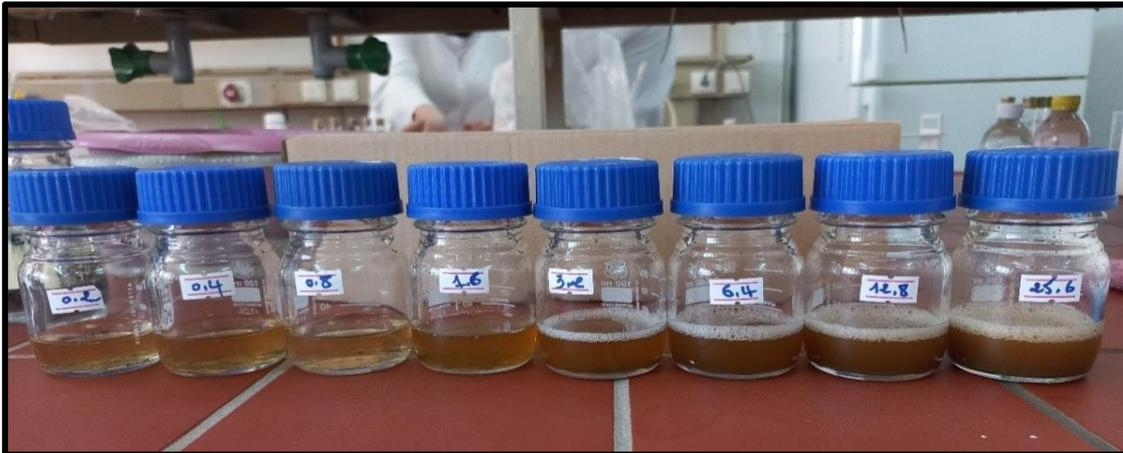
**Figure n°09** : préparation des concentrations d'extrait méthanolique dans le bouillon Muller-Hinton.
