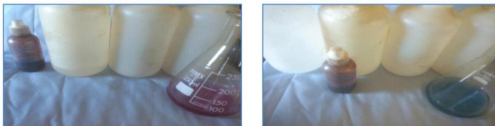
**Figure 09.** Photos montre la variation de couleur avant et après titrage par la solution EDTA pour analyser la dureté
