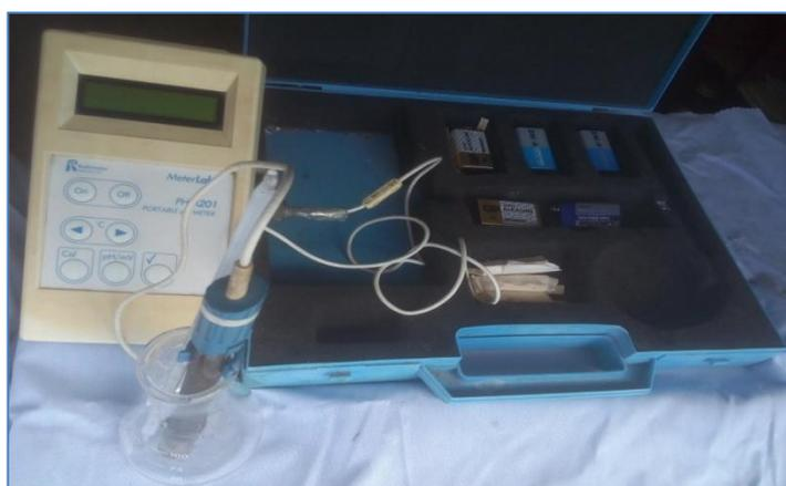
**Figure 08.** Photo de l'appareil pH-mètre utilisé
