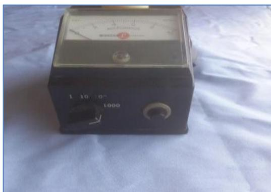
**Figure 11.** Photo de l'appareil conductimètre utilisé
