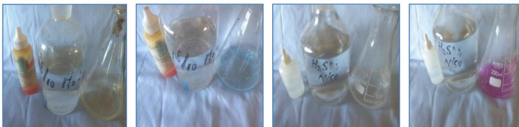
**Figure 10.** Photos montrent la variation de couleur avant et après titrage pour analyser l'alcalinité TA et TAC
