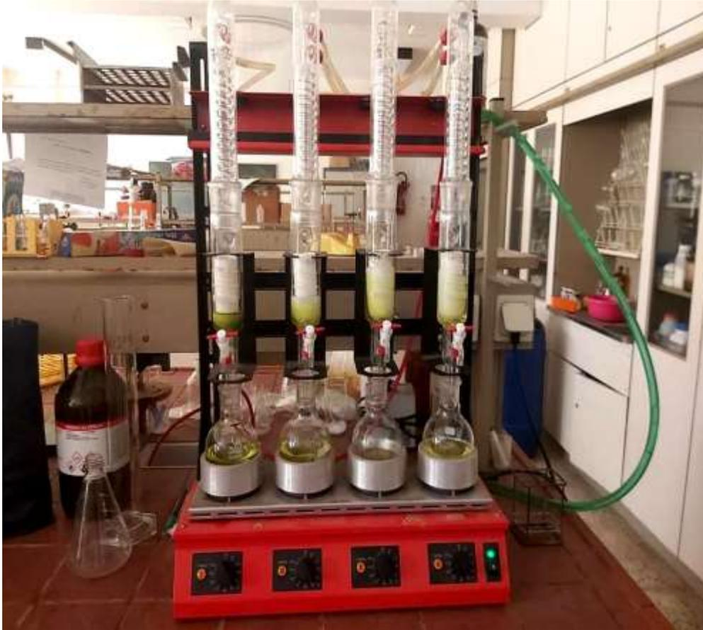
**Figure 15** : l'extraction des HAPs à l'aide du dispositif Soxhlet
