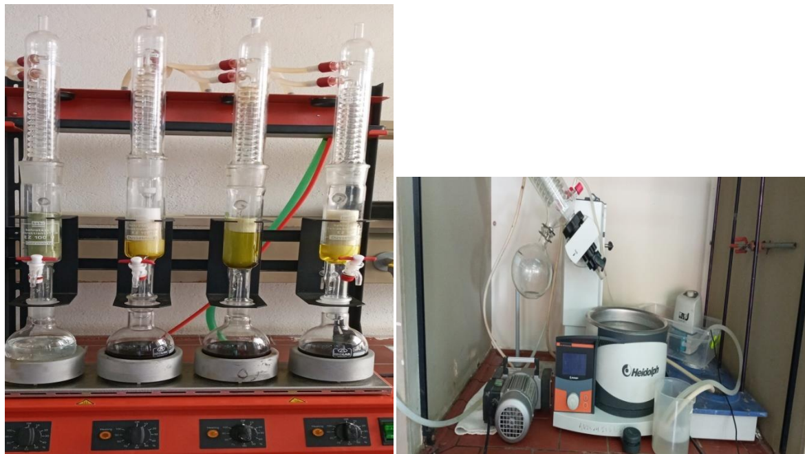
Figure 10: la délipidation par soxhlet et séchage avec l'évaporateur rotatif.
