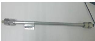
L'analyse chromatographique HPLC est réalisée sur un appareil de type Waters alliance e2695, lié à un détecteur de type UV/visible 2489 connecté à un ordinateur pour le traitement des données, d'un module de marque Waters 2695 qui fait l'injection automatique, d'une pompe à deux pistons, d'une électrovanne, d'un dégazeur, d'un four dans lequel se trouve une colonne (250 mm × 4,6 mm) avec une phase stationnaire C (5 μm) Thermo C18.
