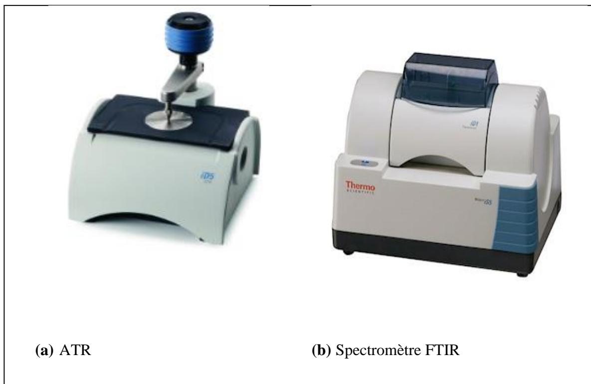
**Figure III.4: Spectroscopie infrarouge.**
