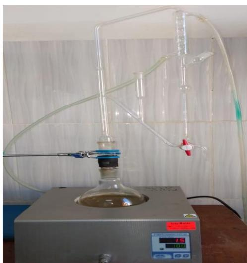
**Figure IV.4 : Dispositif d'hydrodistillation conventionnelle utilisé pour l'extraction des huiles essentielles.**
