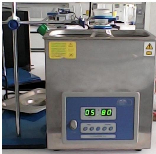
**Figure IV.1: Dispositif utilisé dans l'extraction assisté par ultrason.**
