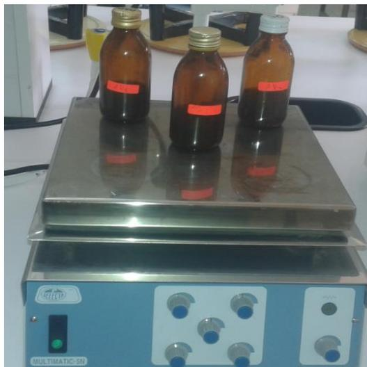
**Figure IV.2: Dispositif utilisé dans l'extraction des composés phénoliques par agitation magnétique**
