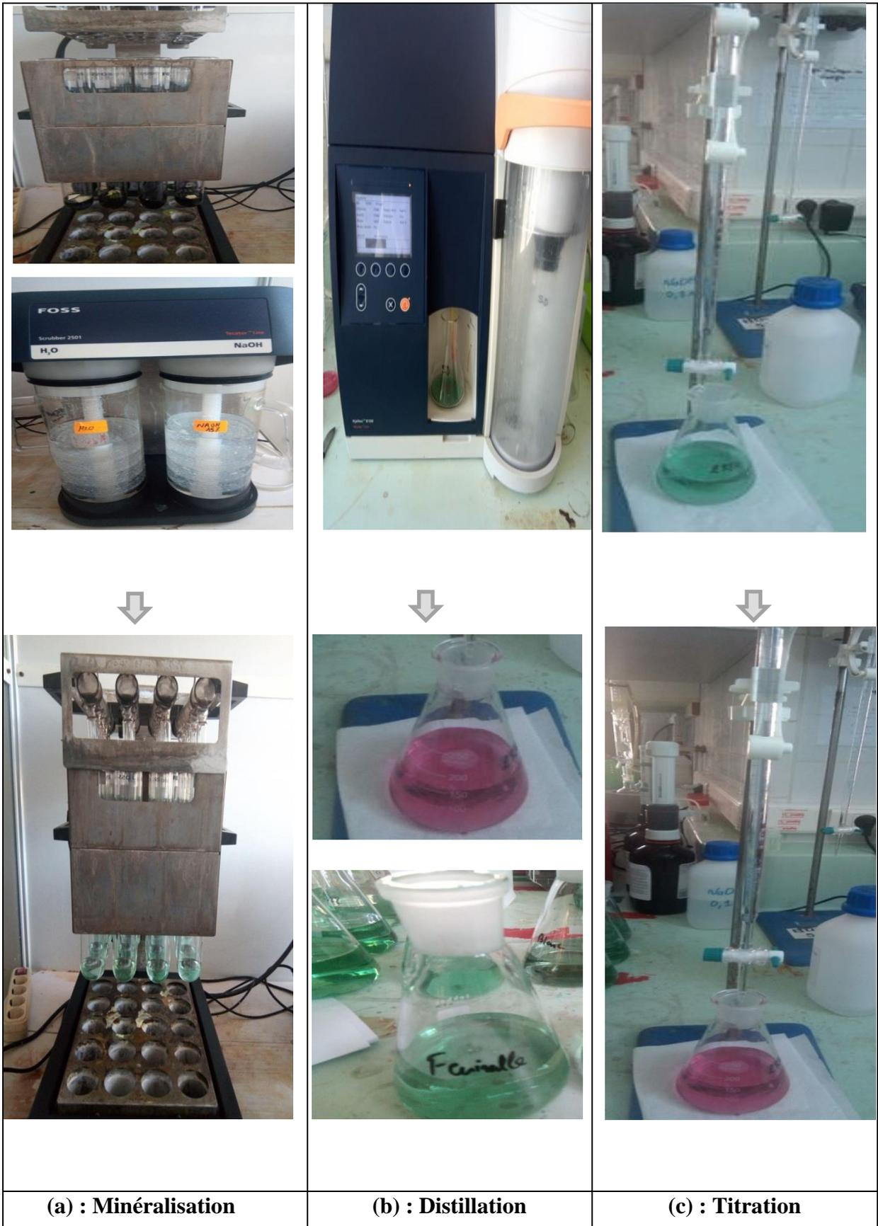
Figure III.3: Détermination de la teneur en protéines
