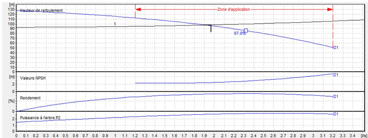
Figure (IV.6) : Les courbes caractéristiques de la pompe 3
