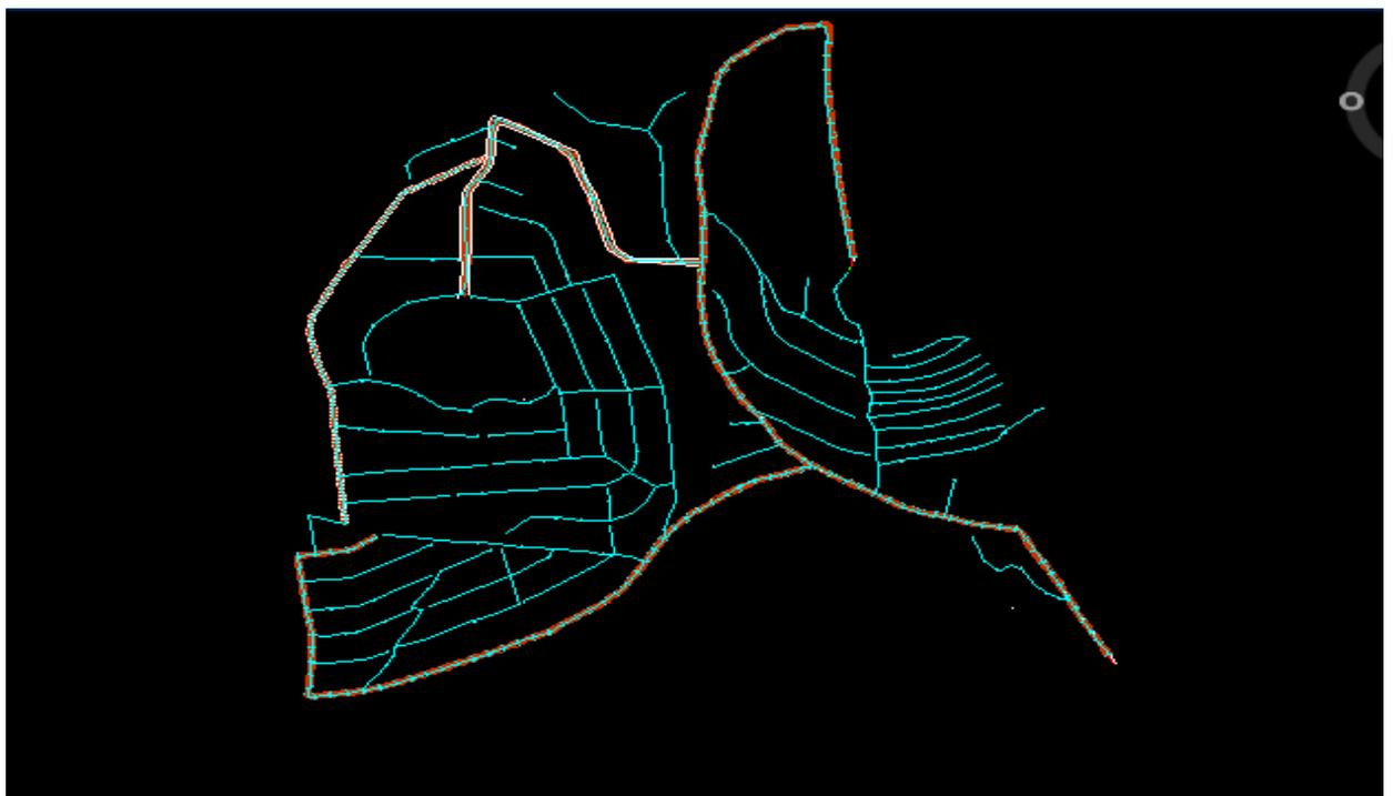
Figure IV. 2: Tracé de réseau des eaux pluviales (Covadis)
