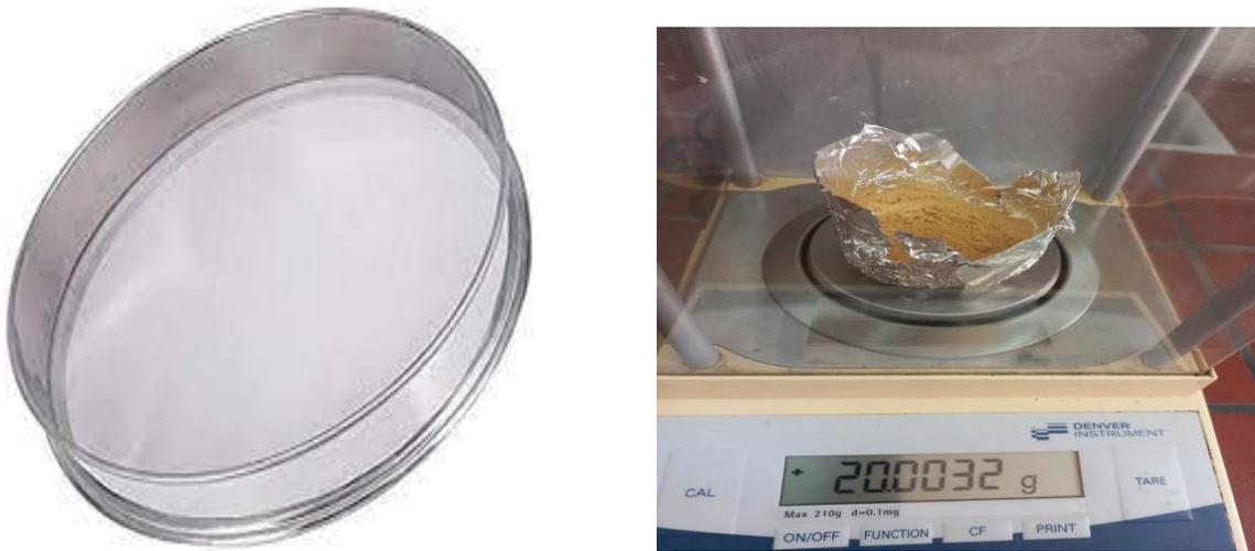
**Figure III.4:** Tamis de 100 µm et balance analytique de précision.
