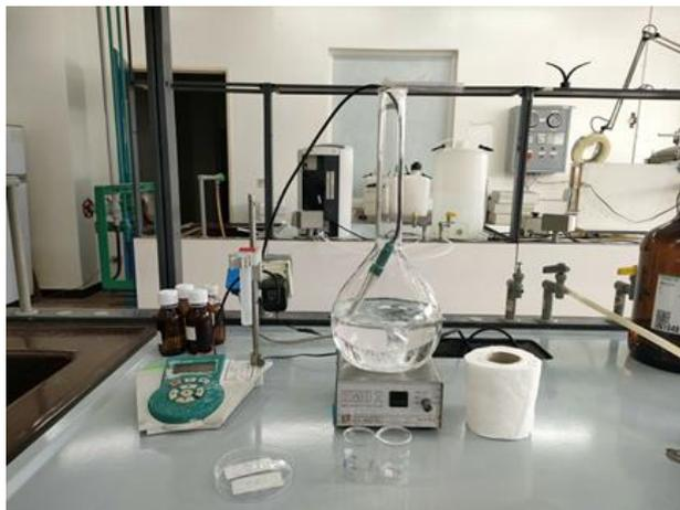
Figure IV.3 : Préparation de la solution tampon à pH 6,8
