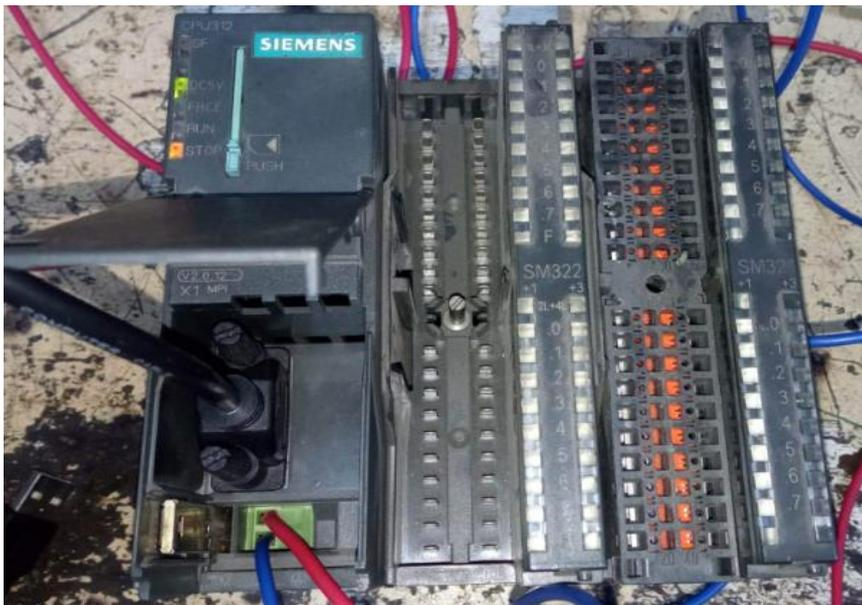
**Figure II-3:** Aspect extérieur d'un automate modulaire CPU 312
