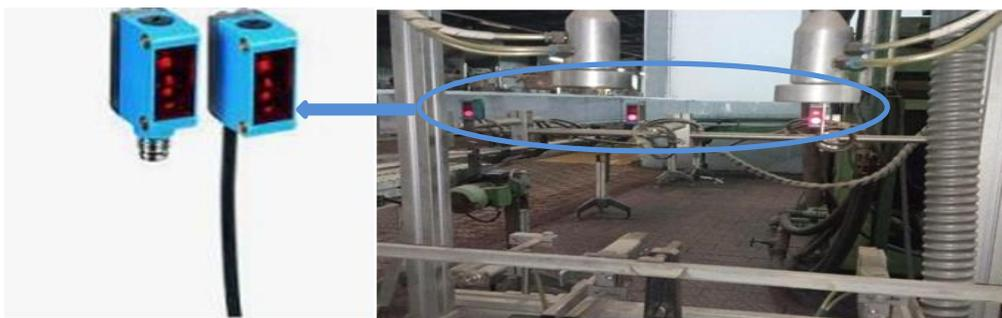
**Figure I-6 :** Capteur photoélectrique (photo prise en entreprise)
