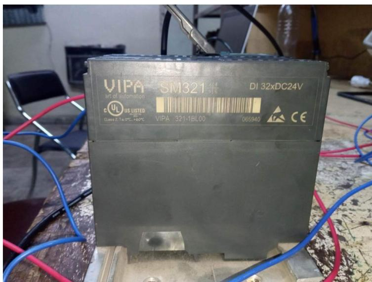
**Figure II-4:** le module SM321 DC d'un API S7-300 (photo prise en entreprise)
