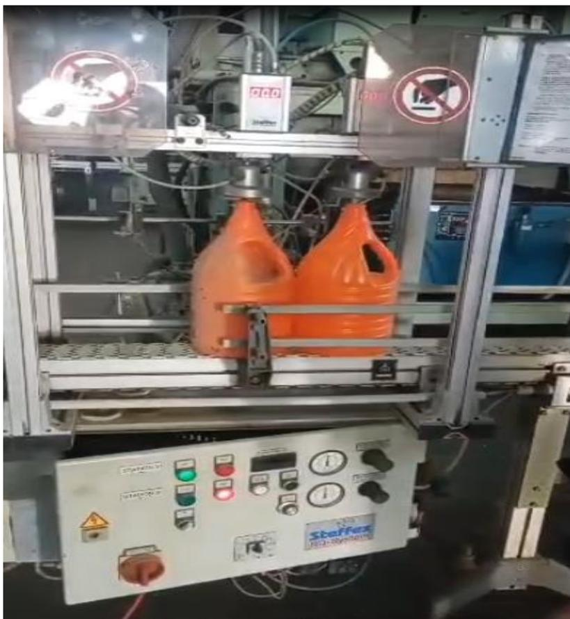
**Figure I-2:** Testeuse de bouteilles 5L PEHD (photo prise en entreprise)
