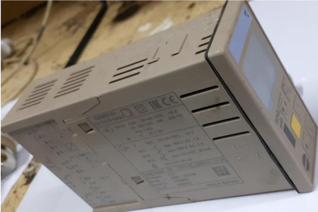
Figure III.8 : Le régulateur Trovis 6493 (photo prise en entreprise).
