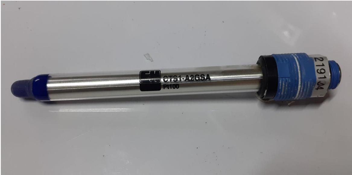
**Figure III.7 :** La sonde de température (photo prise en entreprise).
