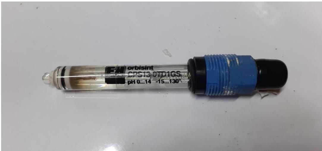
**Figure III.5 :** La sonde du ph (photo prise en entreprise).
