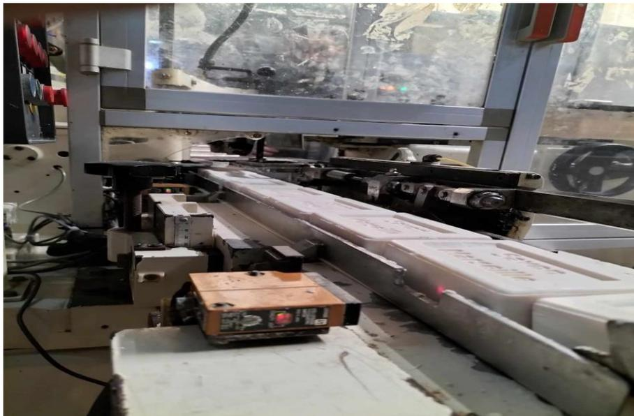
**Figure I.2 : Partie détection savon sur le tapis**
