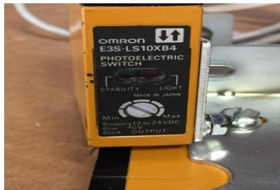
Figure I.6 : Photocellule B2 et B22
