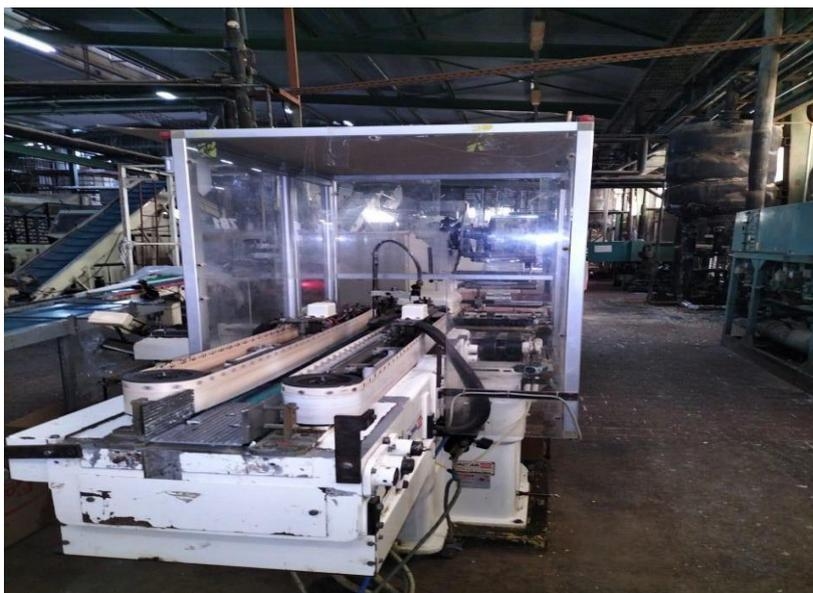
**Figure I.4 :** Partie soudage horizontal du film et savon
