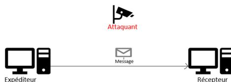
FIGURE 1.11 – Une attaque passive
