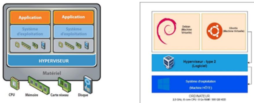
FIGURE 4.4 – virtualisation des systèmes d’exploitation de type 1 et 2 [30]
