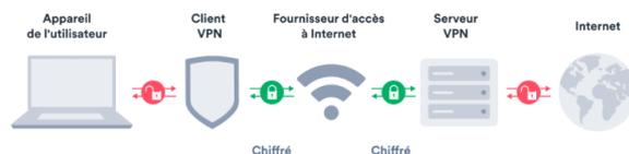
FIGURE 1.16 – La sécurité par la mise d'un VPN
