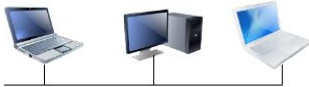
FIGURE 1.1 – Topologie en bus
