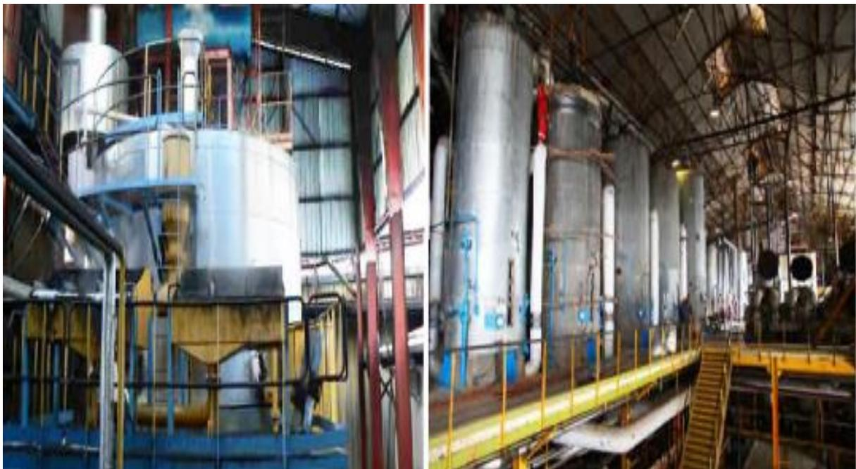
**Figure I.3 :** Les machines utilisées pour le chaulage et la carbonatation
