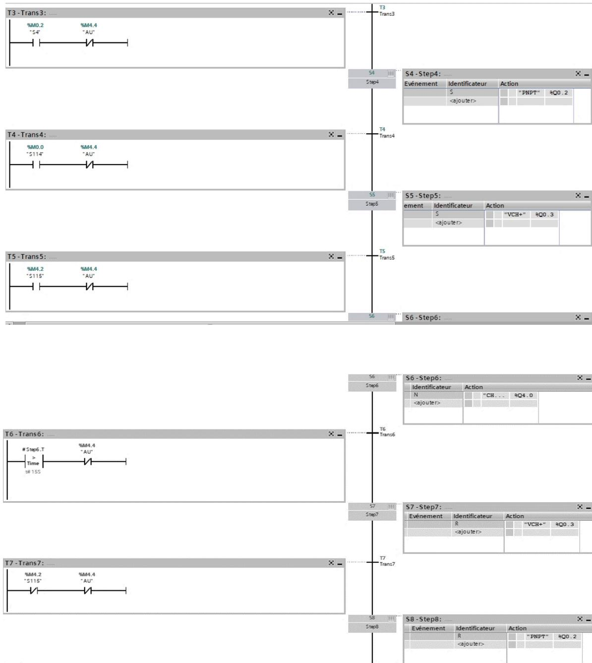
Figure.III.4 : Partie de chargement de la masse cuite.
