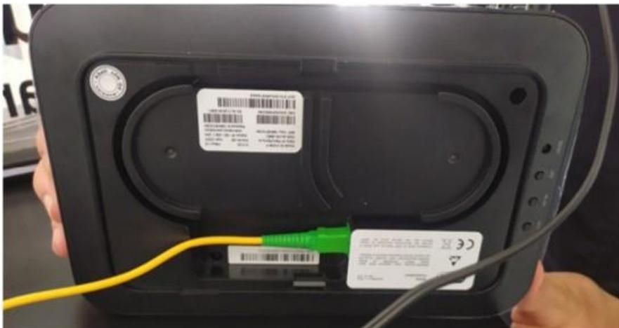
**Figure III.20** : Modem connecté à une PTO par une jarretière optique
