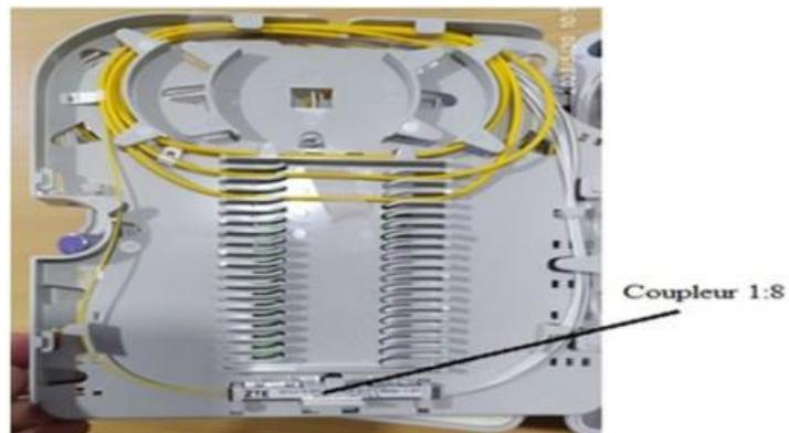
**Figure III.15** : Coupleur PLC 1:8 prépositionné.
