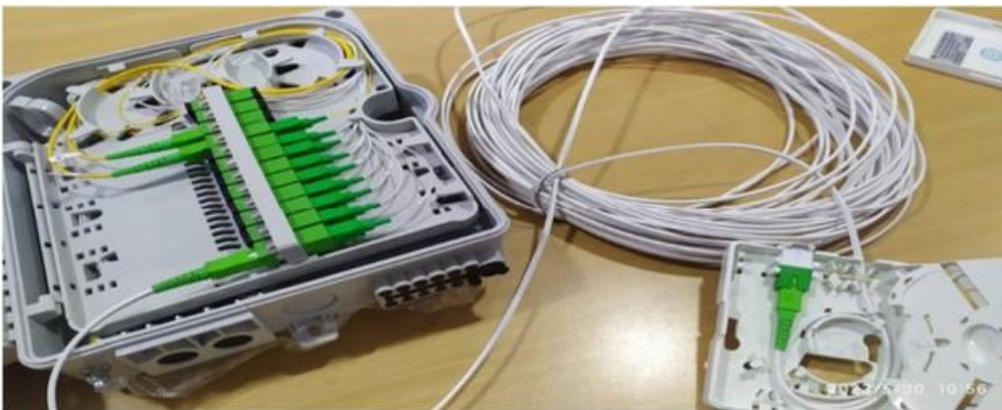
**Figure III.17** : PTO connecté au PBO par un Kit de câble d'un seul brin
