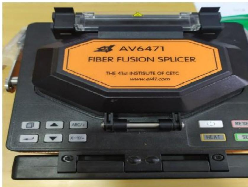
**Figure B.1 :** Fusionneuse (soudeuse)
