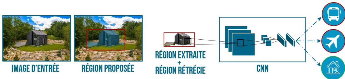
Figure II.5 : Architecture et fonctionnement du model R-CNN
