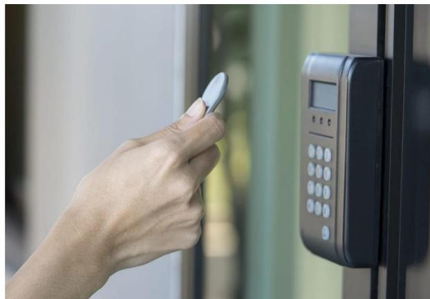
**Figure1.11** : Système de présence basé sur RFID [35]
