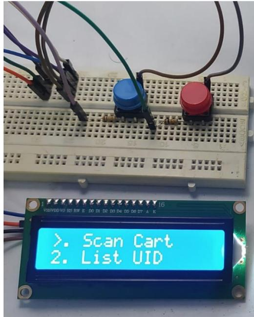
**Figure 3.16 :** Teste de l’LCD et les boutons [34]
