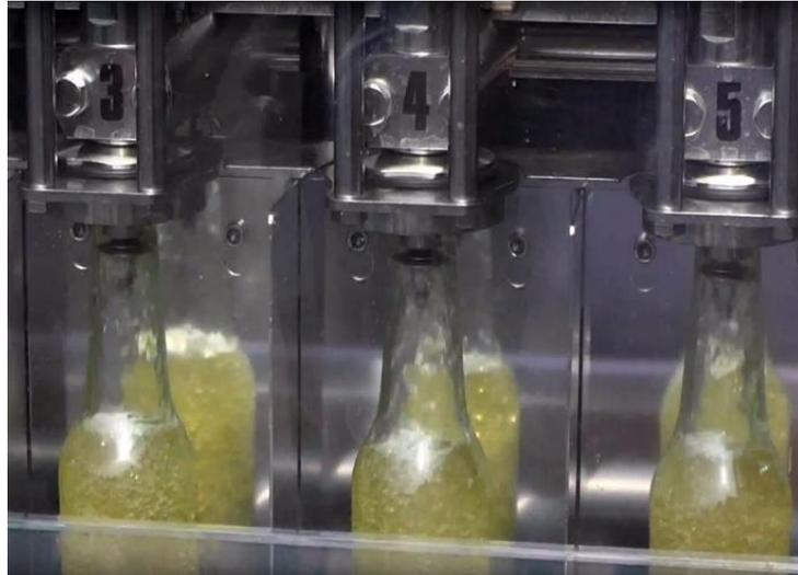
Figure II.7: becs de remplissage
