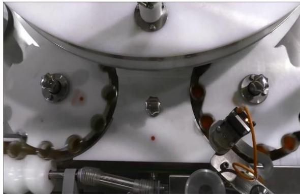
Figure II.5: Etoile pour machine d'embouteillage [5]
