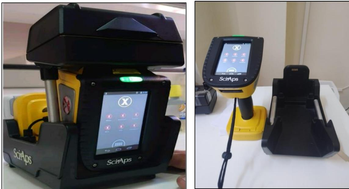
**Figure II.5 :** Spectromètre à fluorescence X (de marque SciAps).
