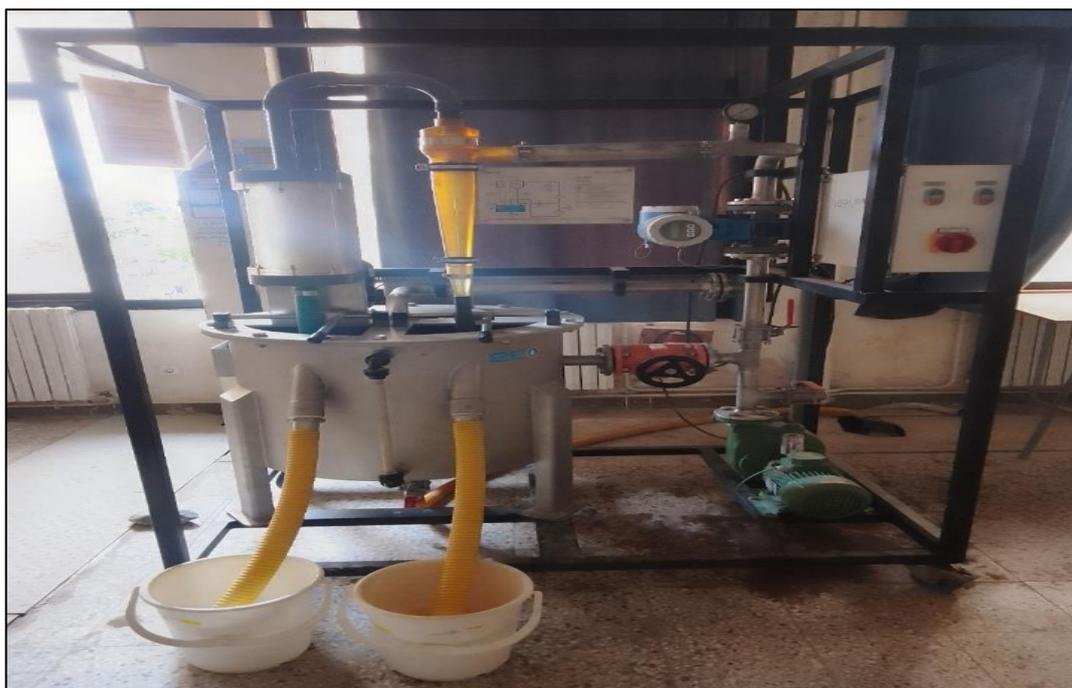
**Figure II. 10** : l'hydrocyclone de type de laboratoire.
