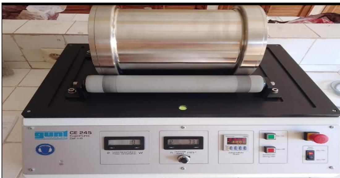
**Figure II.9 :** broyeur à boulettes (de marque CE425 Kugelmuhle Ball mill).
