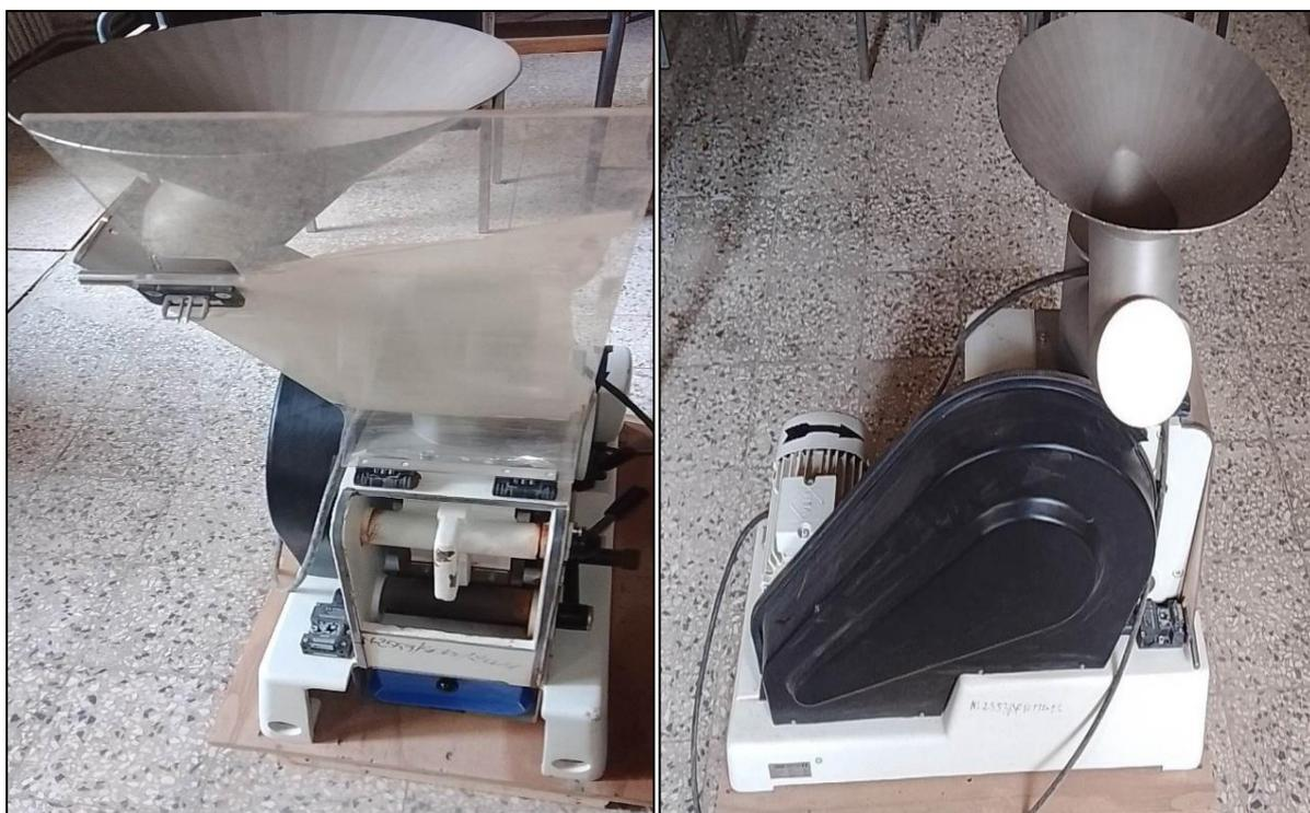
**Figure II. 7 :** concasseur à mâchoire (laboratoire préparation mécanique)
