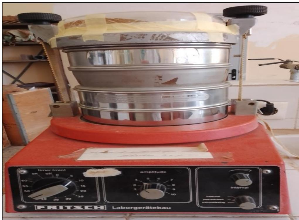
**Figure II.1:** Opération de tamisage (laboratoire préparation mécanique).
