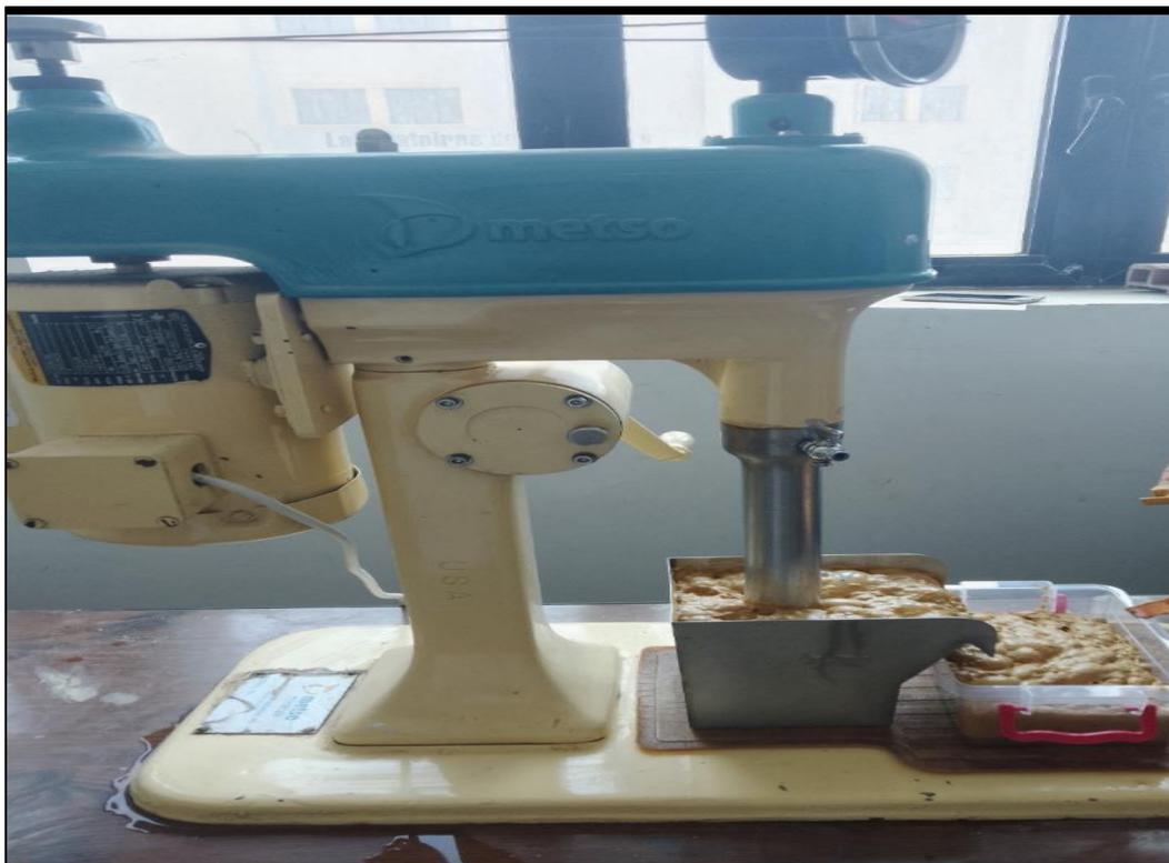
**Figure II.11 :** Cellule de flottation de laboratoire.
