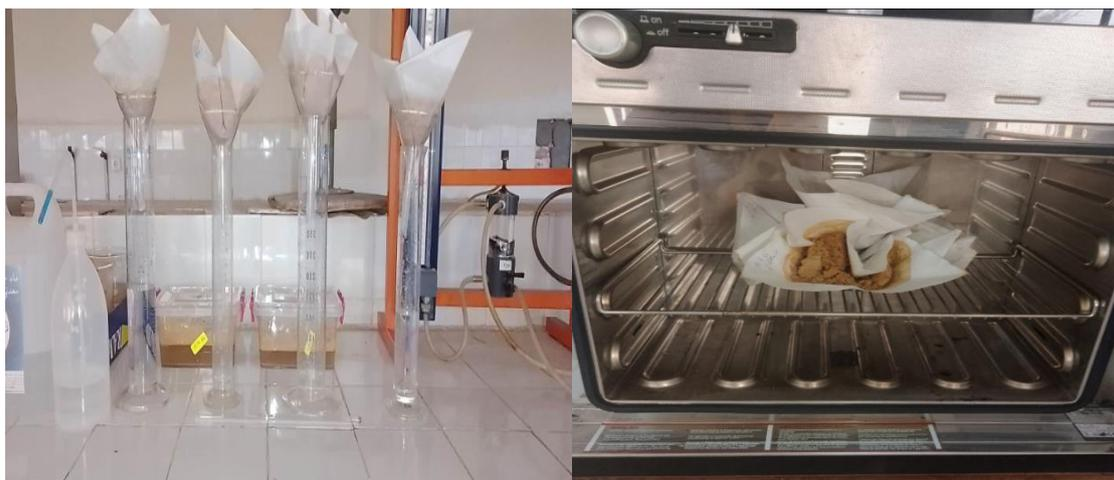
**Figure II.13 :** Méthode de filtrage et séchage par la flottation de laboratoire.
