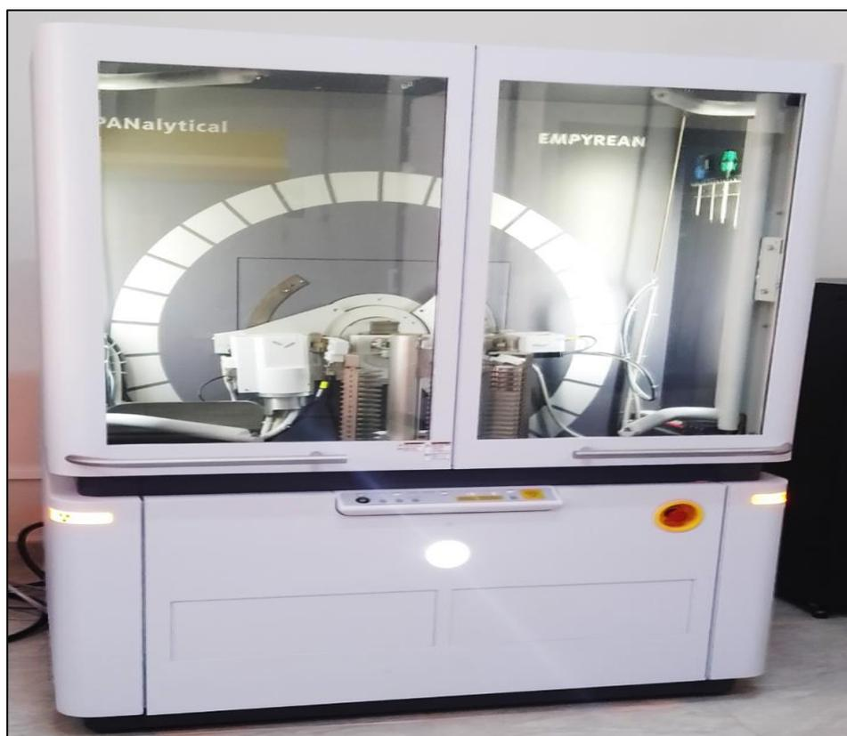
**Figure II.3:** Diffractomètre a rayons X (CRAPC. Bejaia)
