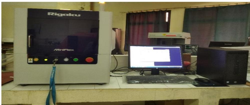
**Figure II-25 :** Appareil de DRX au niveau de laboratoire LPCMC à l'université de Bejaïa
