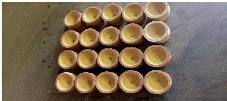
**Figure II-17 :** Perles d'Ag et Au dans les coupelles (photo prise)
