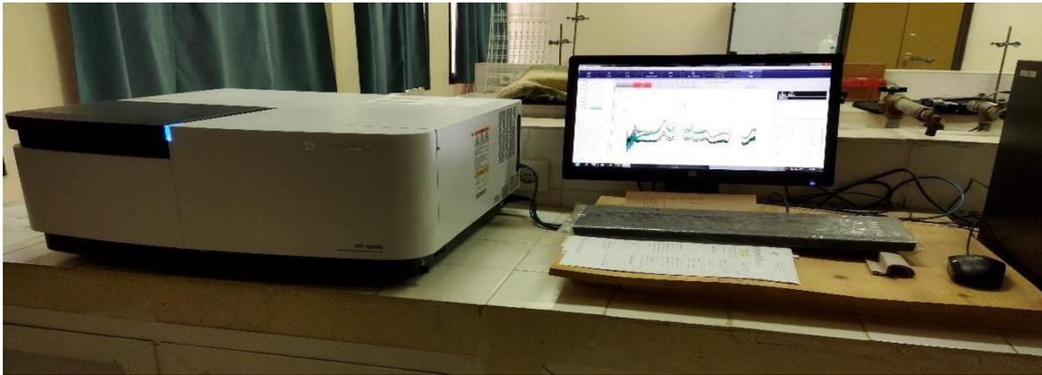
Figure II-28 : Appareil de photoluminescence de laboratoire LPCMC au niveau de l'université de Bejaïa.
