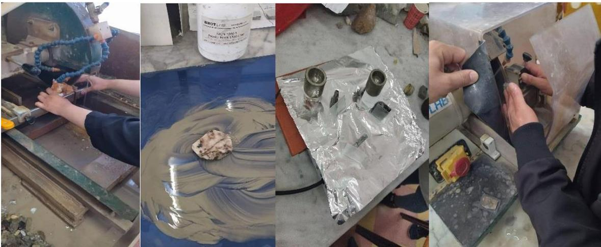
**Figure II-29** : Les étapes de la préparation des lames minces et des sections polies
