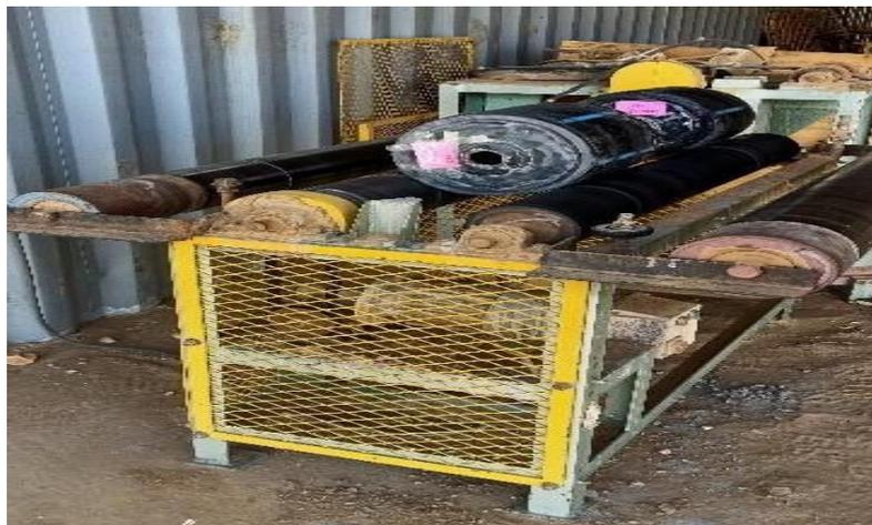
**Figure II-21** : Dispositif de rotation des bouteilles roulantes (photo prise).
