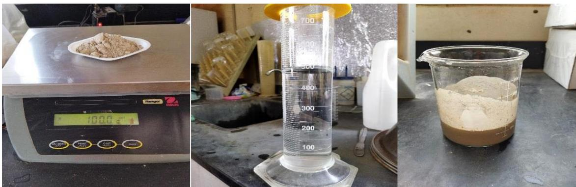
**Figure II-24 :** Etapes de preparation de melange pour la decantation (photo prise)
