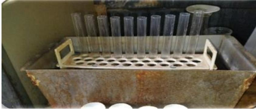
**Figure II-18 :** Des tubes à essais contenant les perles sur bain-marie pour refroidissement (photoprise).
