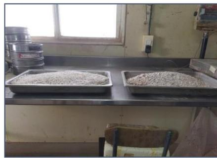
**Figure II-7 :** Le minerai homogène passer par le diviseur (photo prise)
