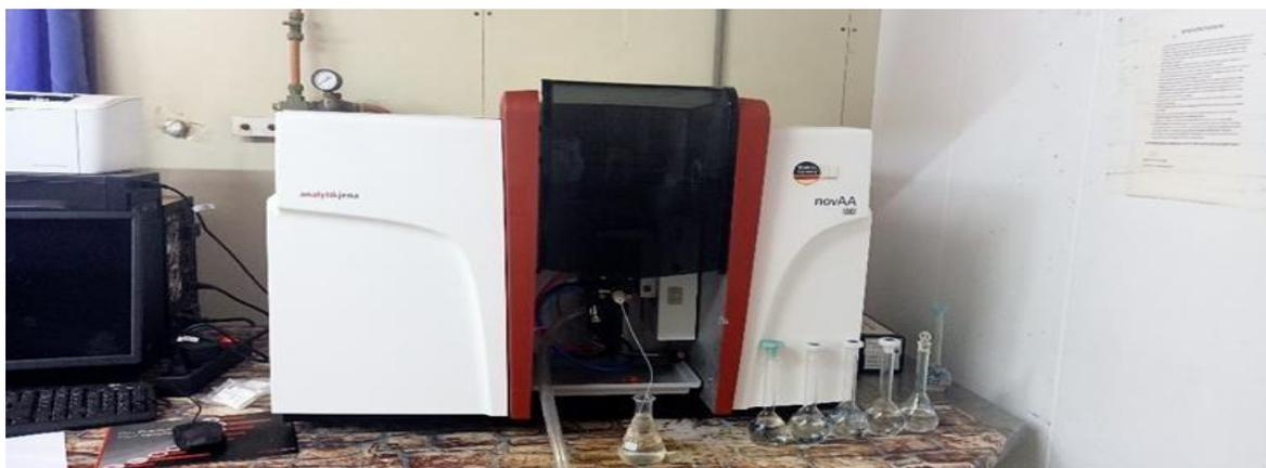
**Figure II-11** : Spectromètre d'absorption atomique du laboratoire d'Amesmesssa(Photo prise)
