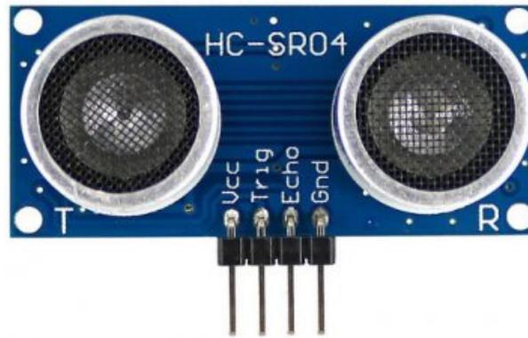
FIGURE 1.3 – Capteur ultrason
