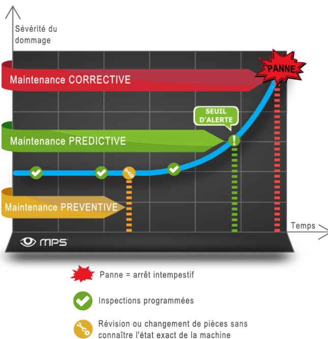
FIG. 4.1 – Courbe représentant le moment où la maintenance se déclenche en fonction de la gravité du dommage[16].
