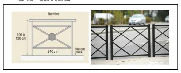
Figure 123: type de bornes pour les trottoirs.
