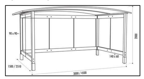
Figure 117: les dimensions d'abris de bus.
