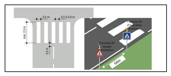
Figure 120: les règles de positionnement des passages piétons.
