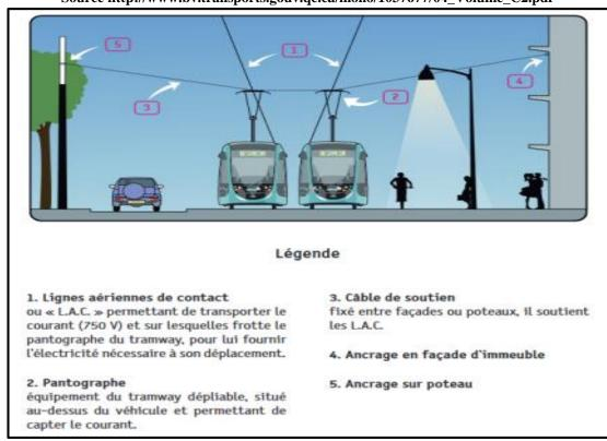
Figure 110: informations d'aménagement d'u tramway électrique.
