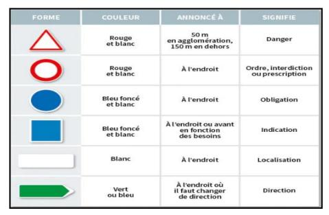
Figure 9: types de signalisation routière verticale
