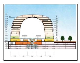
Figure 42: Image illustrant le positionnement du parking.
