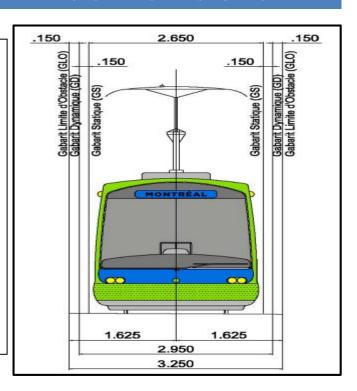
Figure 109: les dimensions et informations techniques d'un tramway.
