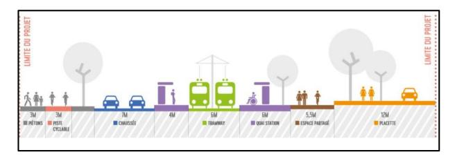
Figure 108: les dimensions des différents aménagements de la chaussée.
