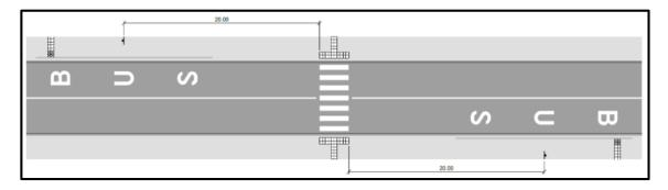
Figure 122: la distance entre l'arrêt de bus et le passage piéton.
