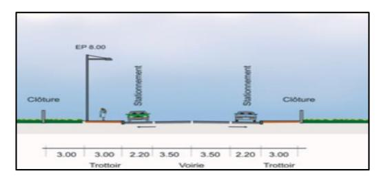
Figure 113: le dimensionnements des voiries mécaniques.
