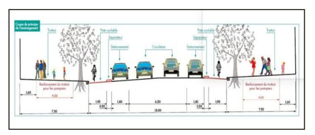
Figure 8: L'intégration et l'aménagement de plusieurs modes dans une voirie de circulation.
