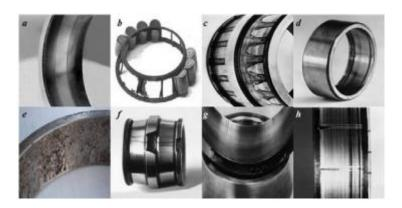
**Figure 20 :** Quelques défaillances affectant les roulements [3] a- Usure généralisée b- Cage détériorée c-Corrosion d- Présence de cratères e- Écaillage f- Fissure et cassure g- Grippage h- Traces
