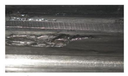
Figure 14 : Écaillage ou Spalling de denture d'engrenage [3]
